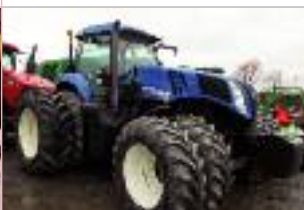
Tracteur New Holland T8.330 , 2011, 1 334 h, Powershift, pesées avant et roues, 620/70R42 et 480/70R30
