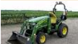
Tracteur John Deere 2320, 24 hp, 2009, 4RM, 691 h, diesel, transm. HST, pneus gazon, 1 sortie d'huile, chargeur JD 200CX
