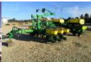
Planteur John Deere 1770, 12 rangs, engrais liquide, disques no-till, marqueurs, moniteur trak-350
