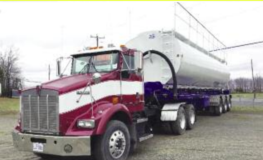
Camion Kenworth T800, moteur CAT C12, essieu avant 14 « full lock », 46 000 lb, transm. 15 vitesses, syst. hydr., remorque 12 compartiments
