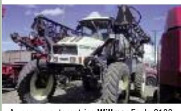
Arroseuse automotrice Willmar Eagle 8100, réservoir stainless 800 gal, 50 triple «nozzles» aux 20 po, Trimble CFX-750 EZ Steer, 88 pi boom et 14.9R46
