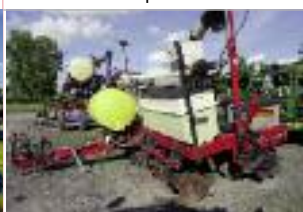
Planteur Case 1200, 6 rangs, engrais sec et liquide, semis-direct, vis et réhausse d'engrais, marqueur
