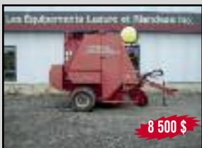
Presse à balles rondes Gehl 1475, balles rondes, chambre variable, hard core, type d'attacheurs à corde, filet, 6 courroies, moniteur, pneus 31x13.50-15, attachement, réservoir d'additif chimique + nozzles
