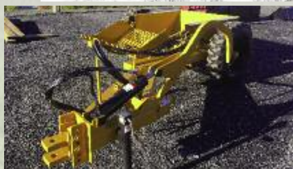
Ramasse-roches, pour les grosses roches avec benne basculante et bras pour extraire les roches prises dans le sol.
