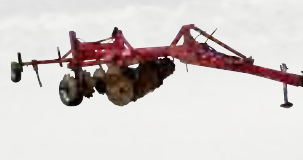
Décompacteur 5 pattes avec rangée de disque
