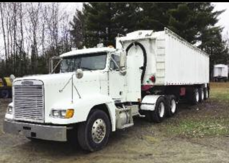
Camion Freightliner, moteur série 60, essieux 12 x 40, transm. 13 vitesses
