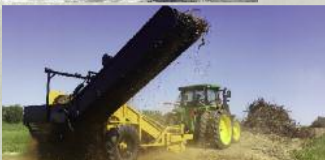
Ramasse-roches, pour les grosses roches avec benne basculante et bras pour extraire les roches prises dans le sol.
