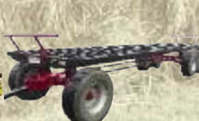
Voiture Miro 30 pi, 18 tonnes, avec ou sans plate-forme, PSD
