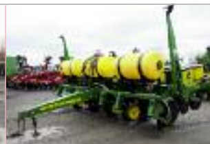
Planteur John Deere 1750 , 6 rangs, engrais liquide, «no-till»
