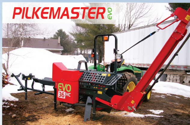
PROCESSEURS À BOIS Pilkemaster EVO 30 TR neufs, avec convoyeur de 13 pi
