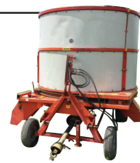
Hache-balles Kidd 807 pour balles de 5 x 6 pi, 2009, sur PTO 540 tr/min
