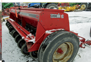
Semoir Case 5300, 12 pi, roues plombeuses, dents effaceurs de traces
