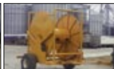
Enrouleur trainé, capacité de 6 à 16 hoses.
