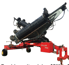
Doubleur d'andains Miller Pro Avalanche 1416, 30 pi, peut entasser 3 andains en 1, avec transporteur
