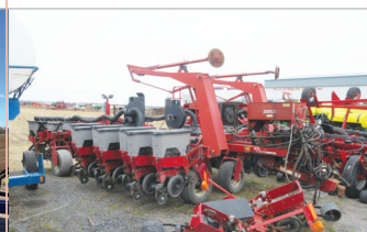
Planteur Case 1200, sur frame Freisen, 24 rangs aux 20 po, à l'air, marqueur, moniteur
