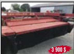
Faucheuse New Holland 415, 1995, 12 pi, largeur de coupe 12 pi, 2 pts trainé, condition- neur à rouleau caoutchouc PTO 1000, pneus 11L15
