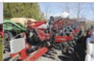
Planteur Case 1240 , 12/23, engrais liquide, disques d'engrais, tasses résidus, trémis central, semis direct, pop-up
