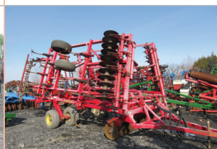
Soil finisher Sunflower 6333, 24 pi, disques avant avec susp., dents de cultivateur, tandem, herse de finition
