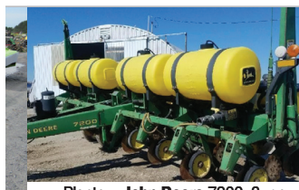
Planteur John Deere 7200, 8 rgs, engrais liquide disques simple, semis-direct conservation, marqueurs, disques openers, clutch à l'air
