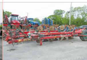
Charrue Kverneland PB115, 4 versoirs réversible, variable hydraulique, disques
