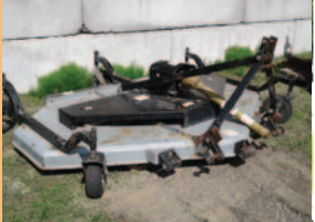
Tondeuse sur gazon (de finition) Douglas , 87 po, décharge arrière, roues pneumatiques
