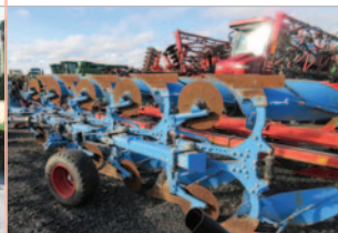
Charrue Lemken Variopale, 5 versoirs, réversible, déclencheur hydraulique, disques
