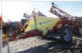
Arroseuse Hardi Navigator 3000, 60 pieds, 800 gal., 3 sections, tank prémélange, moniteurs Hardi
