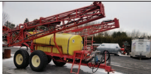
Pulvérisateur Gregson Z , 1000 gal., rampe 90 pi, pompe hypro, roues tandem 14x24 po, console 450 Raven, 5 sections
