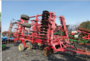
Soil finisher Sunflower 6333, 24 pi, disques avant avec susp., dents de cultivateur, tandem, herse de finition
