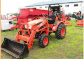
Tracteur Kioti CK20SH , 2009, 814 h, diesel, 4RM, transm. hydrostatique, pneus industriels, chargeur avant
