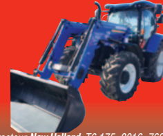
Tracteur New Holland T6.175, 2016, 762 h, 4RM, chargeur NH 845TL, susp. avant et cabine, transm. Electroshift 17X16, 50 km/h, pneus 600/65R38 arrière et 480/65R28 avant, comme neuf
