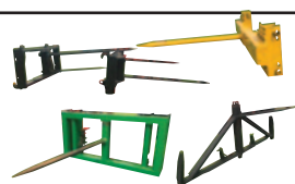
Choix de pics à balles : ALO à double pointe, les autres à 1 pointe : 1 pour chargeuse, 1 autre avec attache rapide pour tracteurs JD 640 et 740 et 1 de fabric. artisanale pour 3 pts
