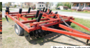
Chisel Case IH 6500 , 9 pattes, disques avant
