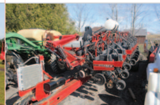
Planteur Case 1240 , 12/23, engrais liquide, disques d'engrais, tasses résidus, trémis central, semis direct, pop-up
