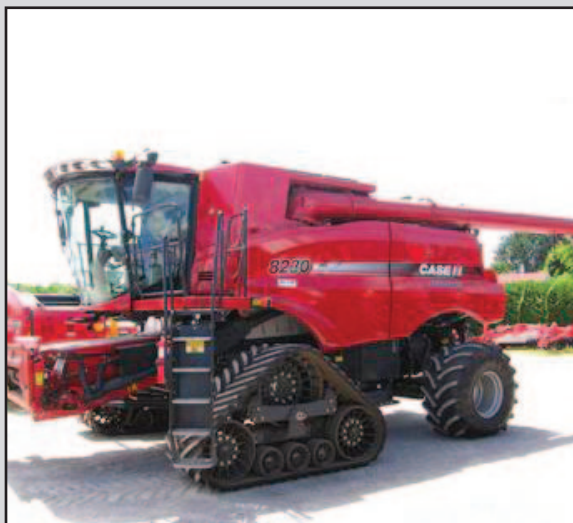
Batteuse Case IH AF 8230, 1216 hM, 2013, 911 h rotor, Big top, Field tracker, GPS, chopper Fine cut, rotor Afx, vis de déchargement 36 pi pneus avant Gy Track, 36 po à 60%, arrière Gy 750/26 à 80%
