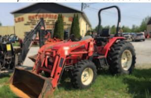
Tracteur Branson 4220i , 4 RM, 42 hp, 1 521 h, transm. 12 x 12 avec renverse mécanique, chargeur et benne avec attache rapide (type skid steer)
