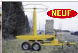
Déroutier Ace DE8H, hyd, repliable et basculant, pour gros rouleau de drain «Maxi»
