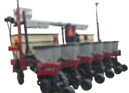
Planteur Case IH 1200 , 6 rangs, avec vis à engrais
