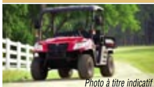
Photo à titre indicatif Véhicule utilitaire Kioti Mechtron 2200, 22 hp, diesel, moteur 3 cylindres, direction assistée, capacité de benne de 1 100 lb
