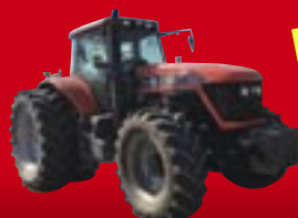
Tracteur Agco DT180A, 2009, 4RM, 4750 h, 200 hp transm. CVT, 50 km/h, roues doubles, susp. complète, pesée avant, écran, tout équipé
