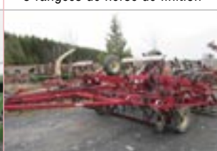
Vibroculteur Kongskilde 2600 , 18 pi, planche, rouleau double
