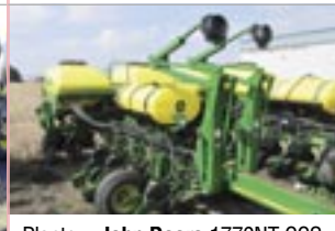
Planteur John Deere 1770NT CCS, 12 rgs, engrais liquide, marqueurs, pression pneumatique, tasses résidus + disc open. vacuum
