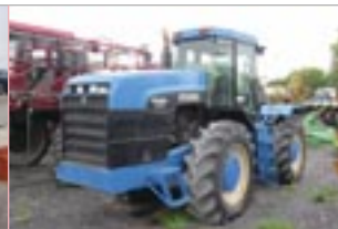
Tracteur articulé Ford 9480, 6 464 h, 20.8-38, 300 hp, Powershift, 3 pts hitch, 4 s. d'huile, roues doubles
