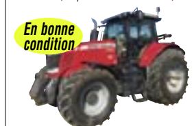
Tracteur Massey Ferguson 7622 Premium, 220 hp, 2013, 4RM, 2 950 h, diesel, transm. Dyna-VT 50 km/h, susp. avant et cab., hydr. et PTO avant, 4 s. d'huile, pneus ballon 710/70R38 neufs, en bonne condition
