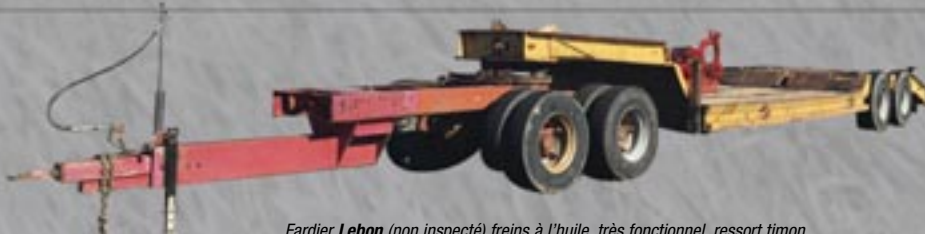
Fardier Lebon (non inspecté) freins à l'huile, très fonctionnel, ressort timon, roues et pneus neufs, suspension attache antichoc (avec immatriculation)
