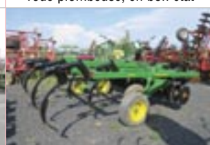
Chisel John Deere 714, 9 pattes, pointes et disques neuf, tandem, disques hydraulique, très propre
