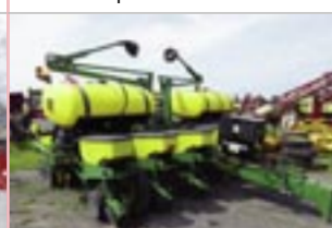
Planteur John Deere 1760, 12 rangs, repliable, boîte longue, réservoir central, Système 20/20
