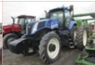
Tracteur New Holland T8.330, 2012, 1 745 h, powershift, 50 km/h, susp. avant et cabine, 480/80R50
