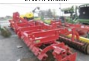
Déchaumeuse Pottinger , 5 m, repliable, rouleau de finition, 3 points
