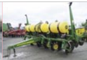
Planteur John Deere 1750 , 6 rangs, engrais liquide, «no-till»
