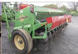
Semoir Great Plains 1300, 13 pi, aux 6 po, engrais, boîte à mils, boîte à brome, marqueur, roues plombeuse
