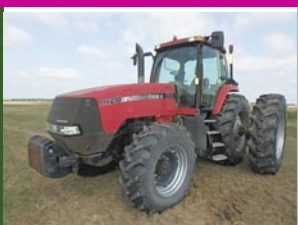
Tracteur Case MX 210, 2004, 4RM, 7 756 h, roues doubles arr., pesée avant
