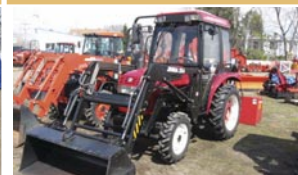
Tracteur Jinma , 25 hp, 2009, 257 h, 4RM, cabine, 3 cyl., à vitesses, chargeur, pneus agricoles, 2 sorties d'huile
