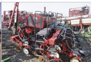
Planteur White 6824, 24 rangs aux 10 po, Vacuum
