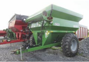
Grain Cart Frontier GC1106, pneu tracteur 24,5-32 (comme J&M 620)
