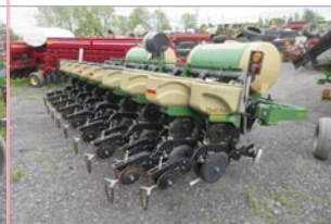
Planteur Great Plains YP825A, 2014, 8 rgs twin rows, engrais liquide, Pop. variable, vacuum, tasses-résidus, moniteurs
