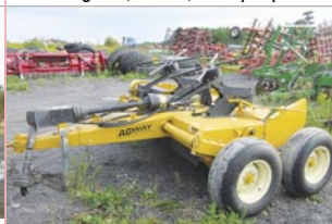
Conditionner à foin Agway (tubeline) 7500T, tandem, toupee épandeur
