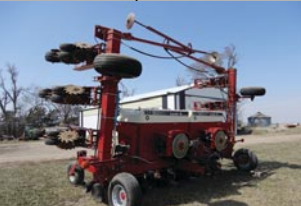
Planteur Case IH 955, 12 rangs repliable, marqueurs, wheel assists, tasse-résidus, moniteur
