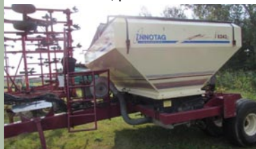
Boîte à semence et engrais Innotag 8242 avec pesée
