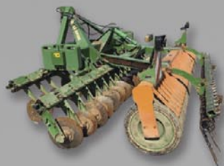
Déchaumeuse à disques Amazon , 3 points, 3 mètres
