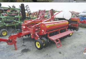
Semoir Sunflower 9433-30, 30 pi en 3 sections, marqueurs, engrais liquide
