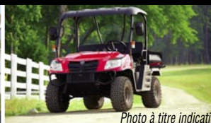
Photo à titre indicatif Véhicule utilitaire Kioti Mechron 2200, 22 hp, diesel, moteur 3 cylindres, direction assistée, capacité de benne de 1 100 lb
