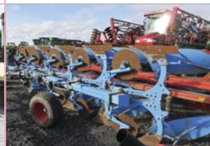
Charrue Lemken Variopale, 5 versoirs, réversible, déclenchement hydraulique, disques
