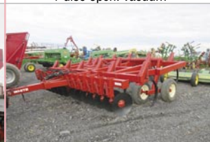
Chisel White , 15 pattes, disques hydrauliques, tandem, disques et pointes neuves
