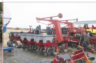
Planteur Case 1200, sur frame Freisen, 24 rangs aux 20 pi, à l'air, marqueur, moniteur
