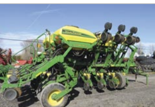
Planteur John Deere 1790CCS, 12/23, pressions pneumatique, ferme rang par rang, engrais liquide, precision planting, 2 points
