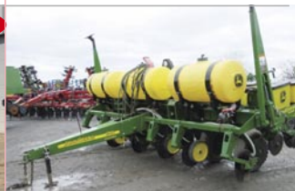
Planteur John Deere 1750, 6 rgs, engrais liquide, «no-till»
