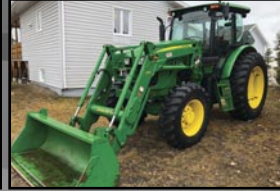
John Deere 6140D , 2013, 4RM, 140 hp, transm. à inverseur assisté 9/9, chargeur JD H310 autonivelant
