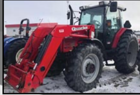
Massey Ferguson 6290 , 2001, 4RM, cabine, suspension avant, 4 sorties d'huile arrière, chargeur Quicke Q770
