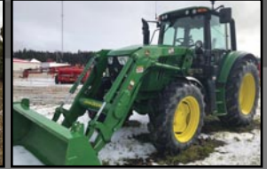
John Deere 6125M , 2014, 4RM, 990 h, 125 hp, cabine de luxe, PowerQuad 24x24, 40km/h, 3 sorties d'huile, ailes avant, 1 balise clignotante
