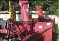
Souffleur à neige Pronovost Puma 94 , 94 po de largeur, rotation et clapet hydrauliques
