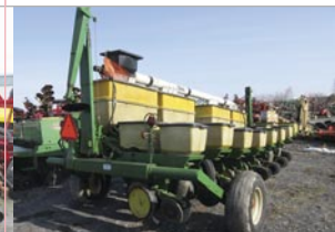
Planteur John Deere 7000, 8 rgs kit de transport, engrais sec, réhausse et vis d'engrais, marqueur
