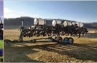
Planteur Kinze 3600 , 12 rangs pivot, engrais liquide, no-till, marqueurs
