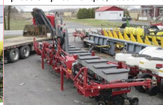
Planteur Case 1200 12 rangs, Stalk-fold, tasses résidus, marqueurs, wheel assist
