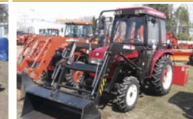
Tracteur Jinma , 25 hp, 2009, 257 h, 4RM, cabine, 3 cyl., à vitesses, chargeur, pneus agricoles, 2 sorties d'huile
