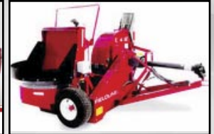
Souffleur à ensilage Fieldline , 1000 tr/min, ajustement de la hauteur par des cylindres hydrauliques, toupie d'alimentation (spinner)
