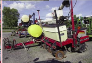
Planteur Case 1200 , 6 rangs, engrais sec et liquide, semis-direct, vis et rehausse d'engrais, marqueur
