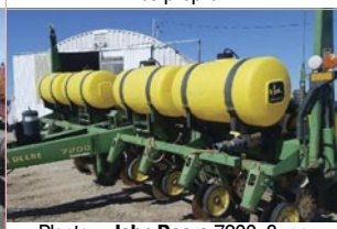
Planteur John Deere 7200, 8 rgs, engrais liquide disques simple, semis-direct conservation, marqueurs, disques openers, clutch à l'air
