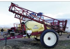
Arroseuse Hardi Commander 1200 gal., 80 pi, moniteurs Hardi
