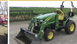
Tracteur John Deere 2320 , 24 hp, 2009, 4RM, 695 h, hydr., pneus à gazon, 2 sorties d'huile, double, chargeur JD 200CX
