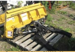
Gratte Metal Pless SM525 , 60 po, cylindre et boyaux (hoses)
