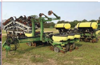
Planteur John Deere 1770, 12 rgs, no-till, engrais liquide, marqueurs
