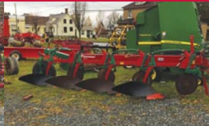
Charrue Kverneland BB115HD, 4 versoirs variables de 12 à 20 po, comme neuve
