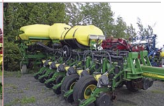
Planteur John Deere 1770NT, CCS, 16 rgs, engrais liquide, «No-till»
