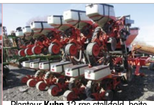
Planter Kuhn 12 rgs stalkfold, boîte ADLS 6t, semis direct, disques d'engrais Yetter, ferme rangs par rangs, à l'air, moniteur
