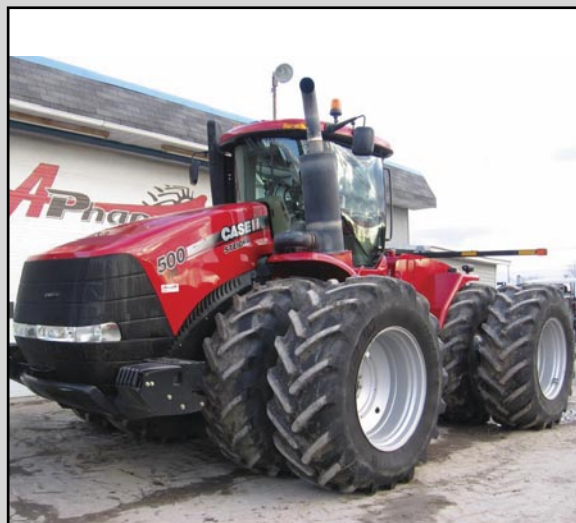
Tracteur Case IH Steiger 500, 500 hp, 2013, 1 700 h, 4RM, cab. de luxe avec susp., lumières HID avant et arr., transm. 16x2 powershift, valve hydr. 4 radar, 3 pts, auto guidance ready, PTO 500, roues doubles av. 710/70R42 arr. 710/70R42, possibilité location long terme P15560
