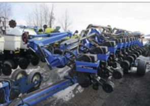
Planteur New Holland SP580, 12 rgs pivots, réservoir central, marqueur, tasses-résidus, no-till
