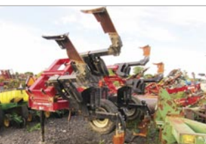
Sous-soleuse Case 2500 , 8 pattes, repliable, avec disques avant
