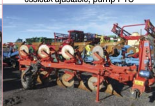
Charrue Kuhn Multi-Master 152, 5 versoirs rév., 3 pts, disques, variable hydr., déclencheurs à l'huile
