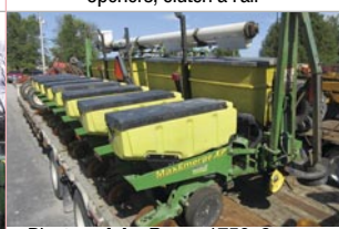
Planteur John Deere 1750, 8 rangs, semis-direct, pression à l'air, boîte 3 minots, réhausse et vis d'engrais, marqueur, à l'air
