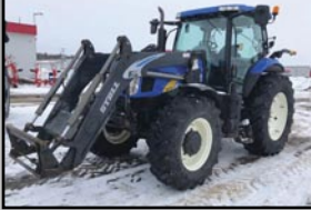
NH T6030 Elite , 2008, 4RM, 5 890 h, 115 hp, cab. susp., transm. à embrayage assisté 18x6, 3 s. d'huile, 20.8PR28 et 16.9R28, chargeur Stoll FZ40 autonivelant
