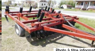
Chisel Case IH 6500, 9 pattes, disques avant
