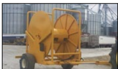
Enrouleur traîné, capacité de 6 à 16 hoses.
