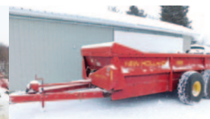
Épandeur à fumier (solide) New Holland 195 , 2 batteurs, pneus ballons et panne à fumier fin
