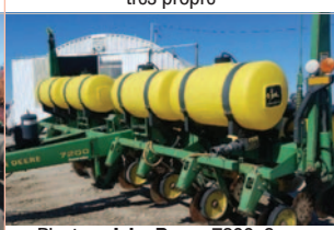
Planteur John Deere 7200, 8 rgs, engrais liquide disques simple, semis-direct conservation, marqueurs, disques openers, clutch à l'air
