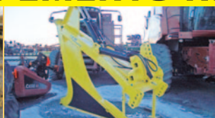
Draineuse ACE DR12 , trois-points, 4 cyl hyd, niveau liquide, pose du 4" et 6", profondeur jusqu'à 7"
