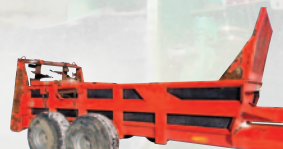
Épandeur Kuhn 2044, hydra-push, porte, pneus ballon
