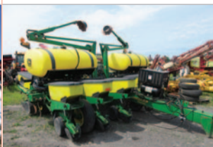
Planteur John Deere 1760, 12 rangs, repliable, boîte longue, réservoir central, Système 20/20
