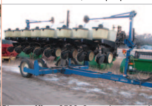
Planteur Kinze 2500, 8 rgs pivot, engrais liquide, marqueurs, tasse résidus, moniteur KPM3000
