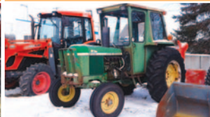
Tracteur John Deere 2130 , moteur diesel 4 cyl., 75 hp, 2RM, 1976, cabine Michon, transmission à vitesses
