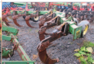
Sous-soleuse John Deere 915, 7 pattes toggle (semi-automatique), roues double de profondeur
