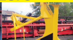
Draineuse ACE Entreprise DR8 , trois-points, niveau liquide, pose du drain de 4 et 6 po, avec teflon
