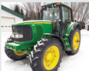
John Deere 7520, 2003, 6 800 h, 4RM, transm. IVT, 40 km/h, susp. avant et cabine, 3 sorties d'huile Pour info : 819 460-3240
