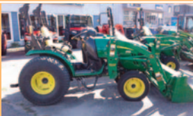
Tracteur John Deere 2520 , 2012, 4RM, hydr., 152 h chargeur JD CX200 , 2 sorties d'huile, pneus à gazon
