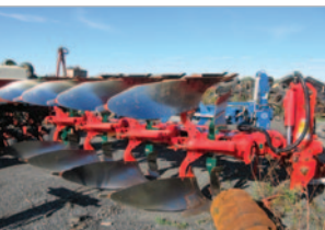
Charrue Vogel Noot XS 1050, ST vario, 4 versoirs, 3 pts, variable hydr., déclencheurs à l'huile
