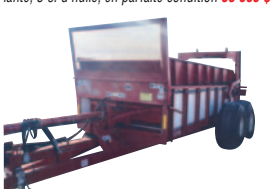
Épandeur Massey Ferguson HY3730VB , 2015, barre de poussée hydraulique, battier vertical avec hausse, panneau hydraulique, pneus ballon, très peu servi 45 000 $
