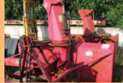
Souffleur à neige Pronovost Puma 94 , chute hydraulique, rotation et clapet hydraulique
