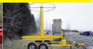
Dérrouleur Ace DE8H , hyd, repliable et basculant, pour gros rouleau de drain «Maxi»
