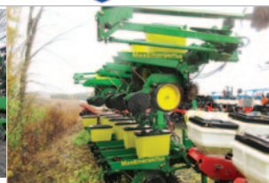
Planter John Deere 1720, 12 rangs stackfold, tasses-résidus, population variable
