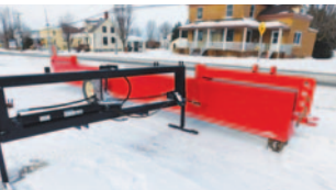
Niveleuse neuve 26 pi. avec carcan à changeur d'angle hydraulique, modèle 20, 24 et 30 pi, disponible durant l'hiver.
