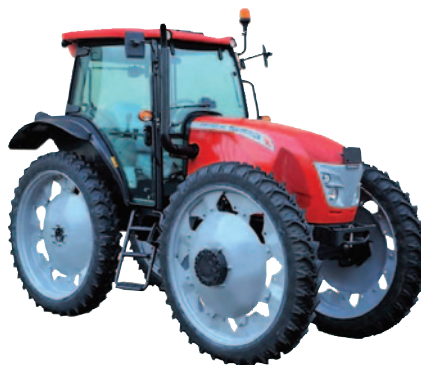
Tracteur, McCormick X50-40M HC, 4RM, spécialisé à haut dégagement, cabine a/c, transm. 36X12 à inv. hydr. et vit. rampantes, 4 sorties d'huile, pneus 11.2R44
