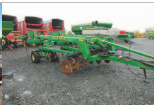
Combo John Deere 2700, 5 pattes, tandem, disques avant sur Rock Flex, disques arr. ajustable hydr.
