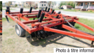
Chisel Case IH 6500 , 9 pattes, disques avant
