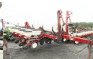
Planter White 6180, 8 rangs, repliable, engrais liquide, «no-till», très propre
