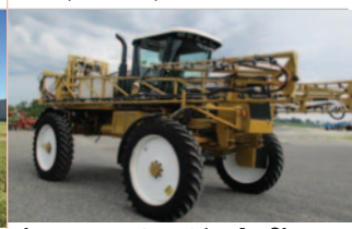
Arroseuse automotrice Ag-Chem 854, 800 gal., 80 pi, 3 700 h
