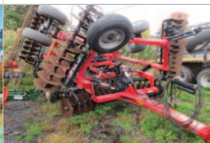
Herse turbo Case IH True Tandem 330, 25 pi, rouleaux arrière
