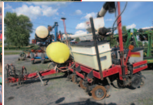
Planteur Case 1200 , 6 rangs, engrais sec et liquide, semis-direct, vis et reheusse d'engrais, marqueur
