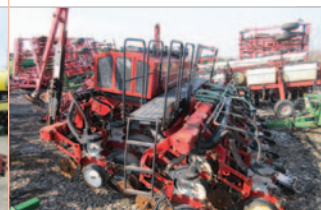
Planteur White 6824 , 24 rangs aux 10 po, Vacuum
