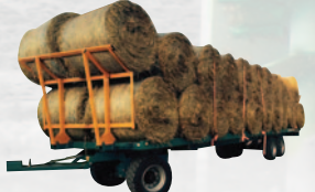
Remorque à foin Rolland RP9006, 30 pi, freinage hydraulique, à sелlette
