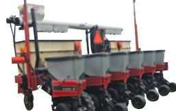
Planteur Case IH 1200, 6 rangs, avec vis à engrais
