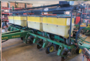
Planteur John Deere 7200 , 8 rangs, semis-direct, reheusse et vis d'engrais, disques simples, Très propre
