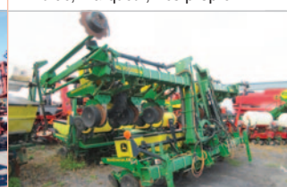
Planteur John Deere 1720, 2010, 12 rangs Stack-Fold, marqueurs, pression pneumatique, vacuum
