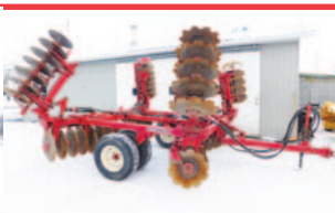
Herse à disques Bush Hog , 54 disques extension hydraulique, disque dentelé en avant, en très bon état
