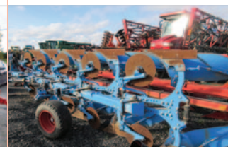
Charrue Lemken Variopale, 5 versoirs, réversible, déclencheur hydraulique, disques
