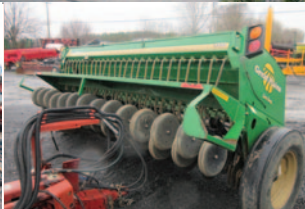
Semoir Great Plains 1300, 13 pi, aux 6 po, boîte à mils, roues plumbeuses
