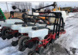
Planteur White 8300 , 12 rgs aux 30 po ou 13 rgs aux 15 po, semi-direct, engrais liquide, marqueur, moniteur
