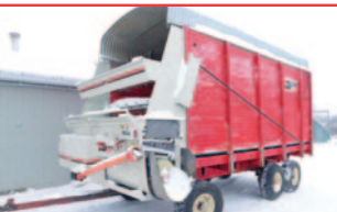
Boîte fourragère Dion 1016SE , trois batteurs, toit et train 6 roues, pneus 11L15, très propre
