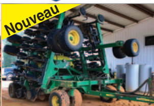
Semoir John Deere 1890, 30 pi, aux 7.5 po, commodité centrale, marqueurs
