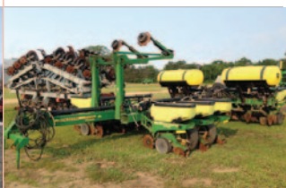
Planteur John Deere 1770, 12 rangs, no-till, engrais liquide, marqueurs
