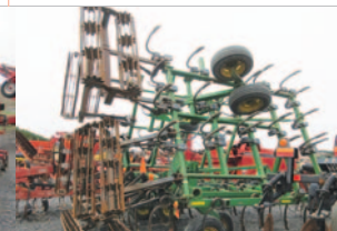
Vibroculteur John Deere 980, 32 pi, grosses dents en «S», tandem partout, rouleau double
