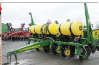
Planteur John Deere 1750, 6 rangs, engrais liquide, «no-till»
