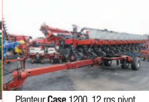
Planteur Case 1200, 12 rgs pivot, engrais liquide, à l'air, semis-direct, réservoir central, marqueur, moniteur, très propre
