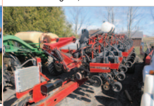
Planteur Case 1240, 12/23, engrais liquide, disques d'engrais, tasses résidus, trémis central, semis direct, pop-up
