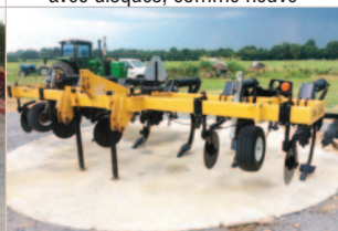
Sous soleuse Landoll 1550, 6 pattes autom. à spring, disques av., disques arr. renhausseur, roues de profondeur
