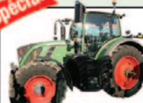
Tracteur Fendt 716V0, 2014, 2 756 h, 160 hp ProfilPlus, pneus 16.9X28 Michelin 60 % bons, 480/80R42 Michelin 60 % bons, hydraulique avant, 4 sorties d'huile arrière
