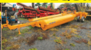
Rouleaux ACE , 34.6" ou 40.6", «heavy duty», 3 sections, 10 000 lb et plus, possible de remplir les rouleaux, avec lumières
