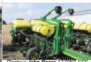
Planteur John Deere 1770NT CCS, 12 rgs, engrais liquide, marqueurs, pression pneumatique, tasses résidus + disc open. vacuum
