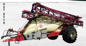
2 pulvérisateurs Hardi Commander, un Commander 9000, rampe 132 pi, 9 000 l et un Commander 6600, rampe 90 pi, 6 600 l
