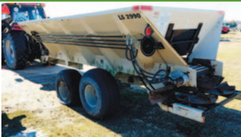
Épandeur Lanco LS2990, 2016, capacité 6 tonnes
