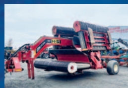
Doubleur d'andain H&S TFM2130, 2013, tri-flex 30 pi continu (3X10 pi), système auto lube 75 000 $
