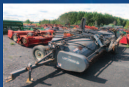
Chopper andaineur à maïs Loftness 240, 20 pi, avec kit de transport hydraulique
