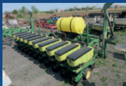
Planteur JD 7200, 10 rgs aux 20", repliable, 3 bu plastique, disc opener, 20/20 moniteur, marqueurs, engrais liquide pop-up, vacuum, pression pneumatique, precision planting
