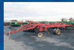
Chisel Sunflower 4510-11, 11 pattes, disques concave avant et arrière
