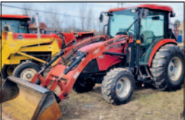
Tracteur Case Farmall 60, 2009, cabine, chargeur à l'avant et excavatrice à l'arrière
