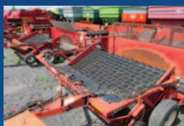
Doubleur d'andain H&S HSM9, 9 pi de pick-up, hydra swing, moteur hydraulique, dents de plastique, extension de 2 pi
