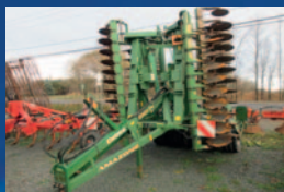
Déchaumeuse Amazona Catros 5501-T, 5,5 metres, repliable, rouleau de caoutchouc
