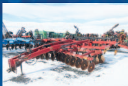
Combo Case IH 730B, 7 pattes sous-soleuses disques avant et arrière repliable hydraulique
