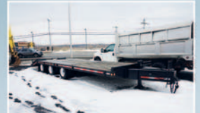
Remorque Asetrail à Timon, 3 essieux, freins à air, suspension à air, planche de 24 pi., descente de 5 pi
