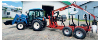
Chargeuse UX713, mât de 13 pi, capac. de levage jusqu'à 2 100 lb, rotation de la flèche de 300°, lame rotative continue. Remorque de 12 pi, pattes basculantes, pôle télescopique pivotante et poteaux mobiles et pivotants, capac. totale de 15 000 lb. Tracteur LS MT468C, 68 HP, pelle de 78 po, capac. de levage de 2 739 lb. Treuil en option.
