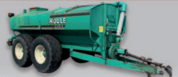
Châssis Houle , 4 roues tandem, freins aux 4 roues, pneus 23.1L26, idéal pour bricoler une remorque à benne basculante (réservoir de 3 000 gal perforé)
