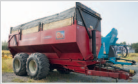
Remorque DM, 2 essieux, directionnel, 22 pi porte ensilage et porte à grains, PTO 1000 tours, pneus 725/65X26
