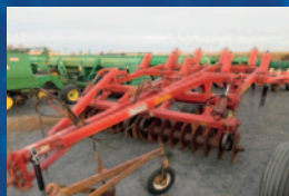
Chisel Sunflower 4212, 9 pattes, tandem, disques avant ajustables hydrauliques, pointes neuves
