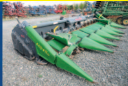
Nez à maïs Capello Quasar 830, 2011, 8 rangs, chopper, capteur de hauteur, attache-ment John Deere
