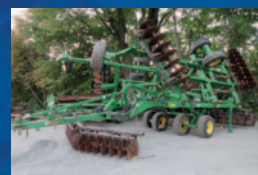
Combo John Deere 2720, 2014, 11 pattes, rouleau internal scraper, tandem, roues de profondeur frontale
