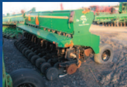
Semoir Great Plains 1510P, 15 pi, distributeur de précision, espacement au 7.5 po
