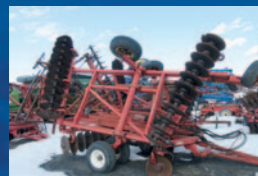
Herse à disques Sunflower 1232, 29 pi, rock flex, gros shaft, roues de profondeur frontale
