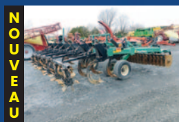
Chisel Great Plains TC5113, turbo chisel, 13 pattes, disques turbo avant ajustable hydraulique, rouleau arrière chopper
