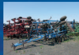
Cultivateur DMI Tigermate 2, 21 pi, 5 barres de pick tooth, tandem dans les ailes, roues de profondeur avant
