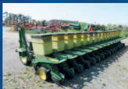
Planteur John Deere 7100, 16 rangs aux 18 po, 3 points, vacuum, disc opener, rehausse de boîte
