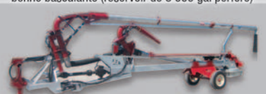
Pompe DM usagée, 3 pts, 24 pi, en acier galvanisé 540 tr/min, tuyau de chargement de 6 po, articulation latérale (photo à titre indicatif)
