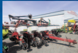
Planteur White 8100, 12 rangs, repliable, tasses-résidus 30 po, minots, pas d'engrais, marqueurs, disques opener
