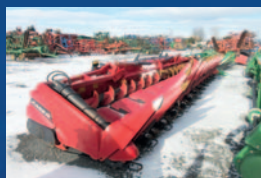
Nez à maïs Case IH 4412F, 2016, 12 rangs repliables, chopper, vis hydrauliques aux extrémités
