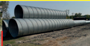
Tuyaux en acier galvanisés, aluminisés, ou galvanisés recouverts de polymère (trench coat)
