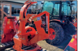
Déchiqueteuse à branches Wallenstein BX52S, capacité de 5 po, alimentation par gravité
