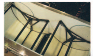
Cuve avec double batteurs de mélange, fond et côtés recouverts d'un plastique antiadhésif et traité UHMW
