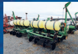
Planteur John Deere 7200 Conservation, 8 rangs, engrais liquide, no-till, vacuum, disc opener + row cleaners, marqueurs, moniteur trak 250
