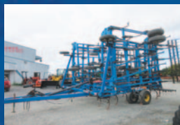
Cultivateur DMI tigermate II, 50 pi, 3 rangées de peignes, tandem, roues de profondeur avant
