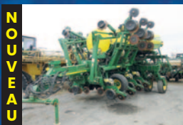
Planteur JD 1790CCS, 12/24, 2014, clutch élec., disques openers, engrais liquide, marqueurs, pression pneumatique active, population hydr., Isobus, plaques à maïs et soya, 129 000 $
