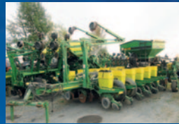
Planteur JD 1770NT, 16 rgs, boîte Aulari ALR 3002, engrais sec, maxEmerge XP, spring 400 lb, disques d'engrais simple, moniteur trak350, balance, marqueurs
