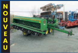
Semoir John Deere 455, 25 pi, roues plombeuses, marqueur Yetter
