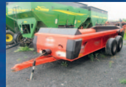
Épandeur Kuhn Knight 1230, tandem, 540 PTO, porte hydraulique
