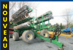
Déchaumeuse Norwood Kwik-till HSD3075, rouleau cage ajustable hydraulique
