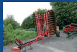
Déchaumeuse Kverneland Qualidisc 6000, 6 m, rouleaux actipack, 2 points
