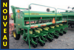
Semoir John Deere 1535, 15 pi, marqueurs, disc opener bubble, pression pneumatique, distributeur de précision
