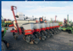
Planteur Case 1220, 8 rangs, engrais sec, rehausse et vis d'engrais, tasses résidus, marqueur, moniteur pro 600
