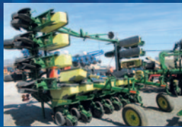
Planteur John Deere 1710, 16 rangs, 22 po, 3 points, wheel assists, marqueurs, Track-250, 3 bu, tasse-résidus, vacuum, drive hydraulique
