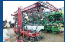
Planteur White 8772, 12 rangs stackfold, semis direct, Spring HD, tasses résidus, marqueurs, boîte 3 bu, moniteur
