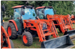
Tracteur Kioti NX5510HC, 2020, 517 h, transmission HST, pneus industriels, chargeur à l'avant
