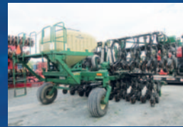
Planteur Great Plains 3PYPA-3115, stack fold, 31 rangs aux 15 po, avec cart pour la semence, écran John IntelliAg
