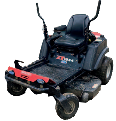
Tracteur à gazon Gravely ZT1944 , 2 RM moteur Kohler 2 cylindres 19 HP, tondeuse 44 p
