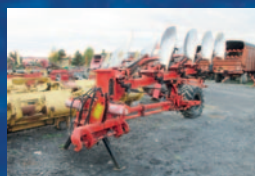
Charrue réversible Grégoire Besson, 4 versoirs, semi-portée, disques, variable, déclencheur à lame
