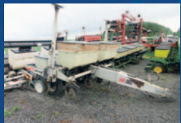
Planteur New Idea, 4 rangs, à doigts, engrais sec, rehausse d'engrais, marqueurs, moniteur, très propre
