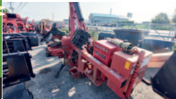
Faucheuse Hardee LR50160, avec bras télescopique
