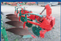
Charrue Kverneland AB100, 4 versoirs, disques, porté, roues de profondeur, variable hydraulique
