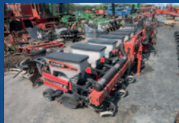
Planteur Case IH 1200, 12 rangs stack-fold, tasse-résidus, moniteur Pro-600 et Accurate, population variable, marqueurs
