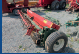
Semoir Brillion SS12, 12 pi, relevage hydraulique, dents pour effacer les traces, semi-porté
