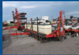
Planteur semi-direct Case 1200, 8 rangs, engrais sec, vis et rehausse d'engrais, no-till, disques Ausherman, marqueur, moniteur
