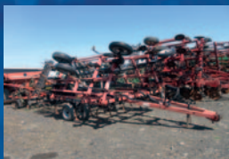
Cultivateur Case Tigermate II, 22 pi, tandem dans la base et les ailes, 4 rangées de peignes, roues de profondeur
