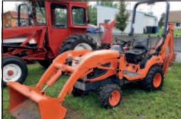
Tracteur Kubota BX25, 2012, transm. HST, pneus agricoles, chargeur à l'avant et excavatrice à l'arrière
