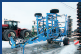
Déchaumeuse à pattes Lemken Karat 9 KUA, 2016, 6 m, 21 pattes, roues de profondeurs, disques niveleur, rouleaux doubles
