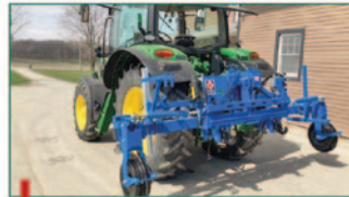
Système de guidage CARRÉ PRÉCICAM par caméra 3D colorimétrique et équipé de disques directionnels
