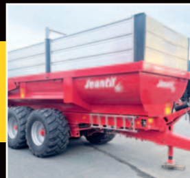
Benne TP 22-29 3 pi de réhausse, pneus 650/55R26.5 BKT, capacité de 20 t grain, paroi Hardox ¼
