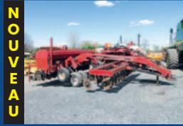
Semoir Case 5400, 15 pi, marqueur, semis direct (no-till), cart Case 5000 avec disques
