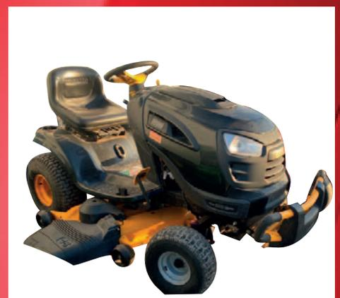
Tracteur à gazon **Craftsman** 26/48, 26 hp, moteur Briggs and Stratton 2 cylindres, tondeuse 48 po, transmission hydrostatique
