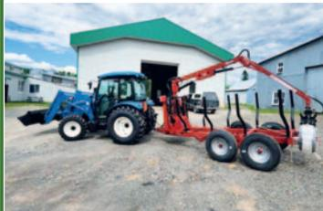
Chargeuse UX713, mât de 13 pi, capac. de levage jusqu'à 2 100 lb, rotation de la flèche de 300°, clame rotative continue. Remorque de 12 pi, pattes basculantes, pôle télescopique pivotante et poteaux mobiles et pivotants, capac. totale de 15 000 lb. Tracteur LS MT468C, 68 HP, pelle de 78 po, capac. de levage de 2 739 lb. Treuil en option.
