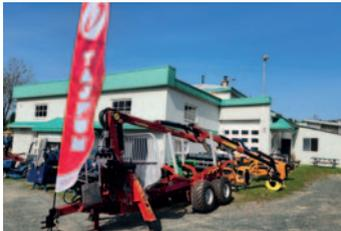
Chargeuses Tajfun DOT40K et GAO90 pour tracteur de 80 à 100 HP, flèche de 23 pi, portée max. de 2 500 lb. Remorque Gap 90 de 22 pi, capac. de charge de 19 800 lb. Standard : rallonge, freins hydrauliques aux 4 roues. Options : treuil de 9 200 lb sur la flèche et valve électrique.
