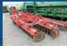
Déchaumeuse Kverneland Qualidisc 4000, 4 m, rouleaux cage ajustable hydraulique
