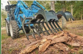
Grappin « polyvalent » MT65572A de 72 po de largeur, 25 po de profondeur et 33 po de hauteur (fermé), 9 dents avec une ouverture maximale de 36 po, 2 cylindres, capacité de levage de 525 lb.
