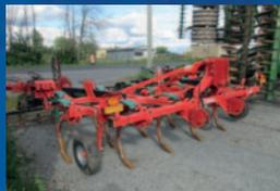
Déchaumeuse à pattes Kverneland CLC PRO, 14 pattes, 2015, portée, dent de vibro et rouleau de finition, très propre
