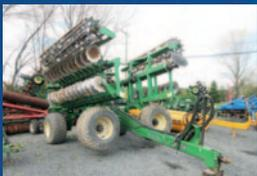
Déchaumeuse Norwood Kwik-till HSD3075, rouleau cage ajustable hydraulique
