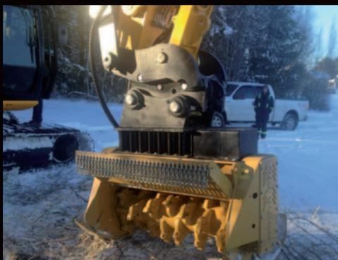
Broyeur hydraulique, pelle, 3 à 35 tonnes
