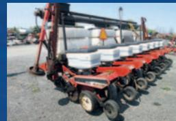
Planteur White 6100, 8 rangs, semi-direct, engrais sec, tasses résidus avec disques opener, Spring HD, rehausse et vis d'engrais, marqueur, moniteur
