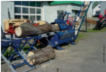
Processeurs à bois de chauffage Tajfun RCA400 et RCA480 pour bois de 16 à 19 po de diamètre, convoyeur pivotant de 16 pi. Ils travaillent vite et bien, fendent en 2, 4 ou 6 quartiers. Options : coins de fendage en 8 ou 12 morceaux, table de levage pour billots, standard ou sur roues.
