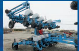
Planteur Monosem NG+3, 12 rangs stack-fold, wheel assists, marqueurs, 3 clutch
