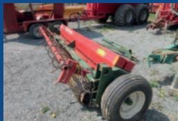
Semoir Brillion SS12, 12 pi, relevage hydraulique, dents pour effacer les traces, semi-porté
