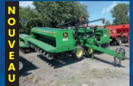
Semoir John Deere 455, 25 pi, repliable en 2 sections, roues plombeuses 4 po, marqueurs Yetter
