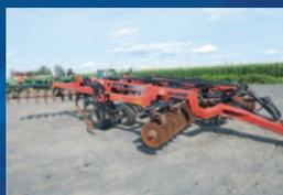
Combo Case IH MRX690, 7 pattes, disques avant et arrière, relevage hydraulique
