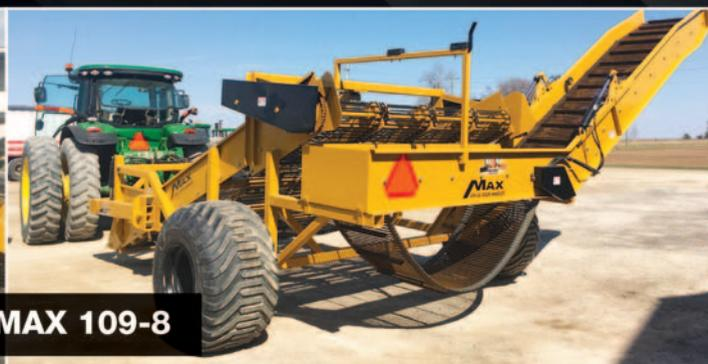
Ramasse-roches, pour les grosses roches avec benne basculante et bras pour extraire les roches prise dans le sol.
