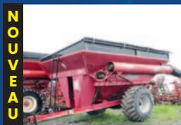
Grain Cart Demco 850, toile, bout de vis rotatif, pneus 30.5-32
