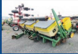
Planteur John Deere 7200 Conservation, 6 rangs, vacuum, spring HD, vis et rehausse engrais, disques simples + tasses résidus, rehausse de boîte de semences
