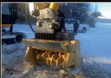
Broyeur hydraulique, pelle, 3 à 35 tonnes
