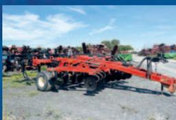
Combo Case IH Ecolo-Tiger 530B, pattes chisel, monté rock flex comme un «C», disques arrière ajustables hydrauliques
