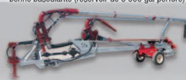
Pompe **DM** usagée, 3 pts, 24 pi, en acier galvanisé, 540 tr/min, tuyau de chargement de 6 po, articulation latérale (photo à titre indicatif)
