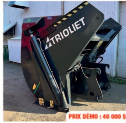
Godet Trioliet Triomaster S300, capacité de 4.1 m<sup>3</sup>, pour chargeur industriel, poids vide 2 150 kg, capacité de charge 1 800-2 000 kg, chargeur poids minimum requis 11 000 kg, avec une capacité de levage minimum de 8 500 kg, avec attache ISO / Volvo inclus, démonstration disponible
