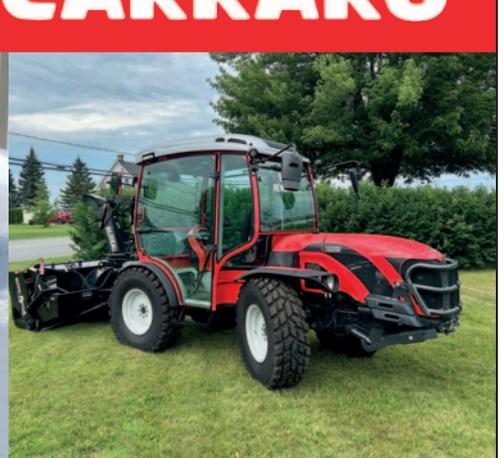
Le SP 4800 avec gratte à trottoir, moteur Yanmar de 38 HP, une machine parfaite pour les endroits restreints.
