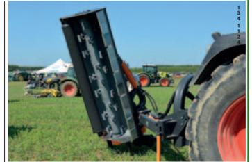
Broyeur ZILLI Riva-E 3 (rouleau débroussaillieur), travaille en latéral ou à l'arrière des tracteurs de 60 à 120 HP, idéal pour l'entretien des bords de champs et des fossés, des haies et des terrains plats, rotation hydraulique de -55 degrés (bas) et de 90 degrés (haut).
