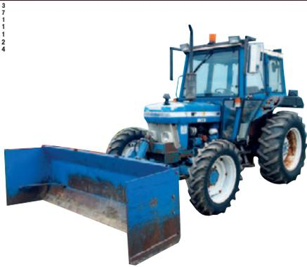
Ford 3910, 1988, 2 000 h, 45 HP, 4 RM, cabine, gratte avant, 2 sorties huile, pompe hydraul. double, transm. synchronisée 8X4, très bonne mécanique
