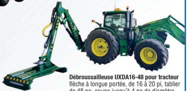
**Débroussailleuse UXDA16-48 pour tracteur** flèche à longue portée, de 16 à 20 pi, tablier de 48 po, coupe jusqu'à 4 po de diamètre
