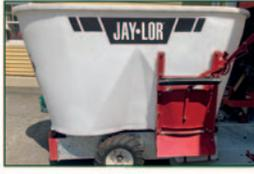
Mini-mélangeur JayLor 5050 autopropulsé, 13 couteaux, capacité de 50 pi<sup>3</sup>
