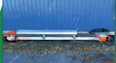
Convoyeur à courroie Valmetal, largeur 18 po, longueur 15 pi, moteur 2 HP, 230 volts, avec jupe et couvercle
