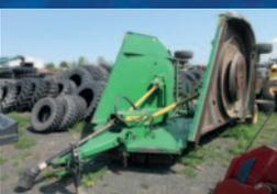
Fauçonneuse John Deere CX20, 20 pi repliable, 3 sections, suspension à l'air
