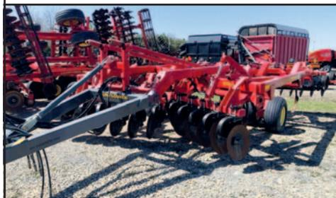
Chisel **Sunflower 4511 09**, démonstrateur, disques individuels à l'avant, espacement de 15 po, groupes de disques à l'arrière, appeler un associé des ventes pour plus de détails.
