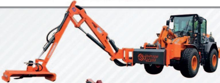
**Débroussailleuse UXDC16-48 pour chargeuse sur roues (loader)**, flèche à longue portée, de 16 à 20 pi tablier de 48 po, coupe jusqu'à 4 po de diamètre
