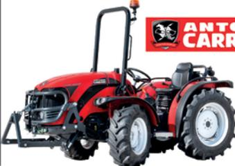
**TIGRE 4800F**, moteur Yanmar, 38,7 HP, poste de conduite réversible, transm. hydrostatique (30 km/h), châssis directeur à roues différenciées, excellente visibilité. OFFERT AVEC OU SANS CABINE. AUTRES MODÈLES SUR COMMANDE.
