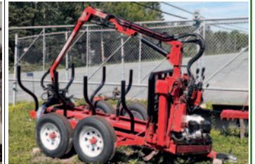
Chargeuse JCB 609, mât télescopique de 9 pi sur remorque FLPH, pneus 205/65R14, unité hydraulique avec moteur Subaru, treuil de 4 000 lb avec câble de 100 pi.
