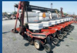
Planteur White 6100, 8 rangs, semi-direct, engrais sec, tasses résidus avec disques opener, Spring HD, rehausse et vis d'engrais, marqueur, moniteur
