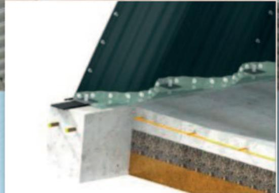
Le dôme est boulonné, aucun coulage de béton ne vient en contact avec la structure.
