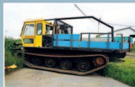
Chenille **Bombardier Go-Track GT-2000 WT**, moteur diesel Cummins 8.3 l, transmission Spicer
