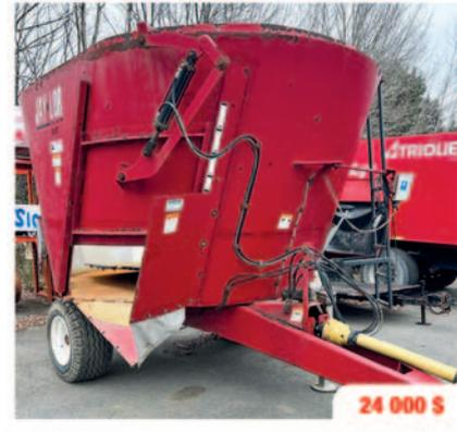
Mélangeur Jaylor 610T, 2016, trainé, PTO 540 série #8, balance stade 04 Dinamica, 1 vis avec 13 couteaux Tungsten, bas des murs refaits en stainless, prêt à fonctionner
