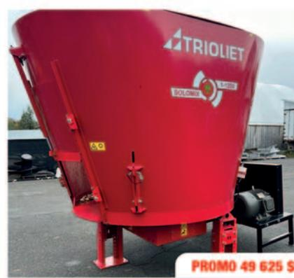
Mélangeur Trioliet Solomix 1-1200, stationnaire, 3 cellules et 1 balance, capacité 500 pi<sup>3</sup>, 1 moteur 30 hp triphasé 240 V
