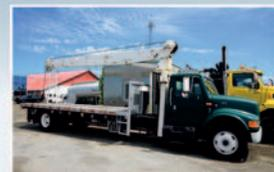
Camion **International 4900**, 6 roues, moteur diesel DT466E, avec grue à câble
