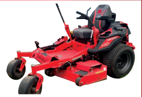
Tracteur à gazon zero-turn Gravelly ZT-HD52 , 2023, 284 h, 25 HP, 52 po, moteur Kohler, ensemble de déchiqueteur inclus, balance de garantie, comme neuf
