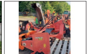
Souffleuse à neige inversée MK Martin , 78 po, rotation et clapet hydrauliques
