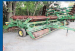
Rouleau émotteur double John Deere 970, 2010, avec pattes en S au centre, 28 pi
