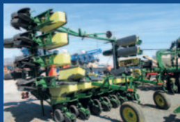
Planteur John Deere 1710, 16 rangs, 22 po, 3 points, wheel assists, marqueurs, Track-250, 3 bu, tasse-résidus, vacuum, drive hydraulique
