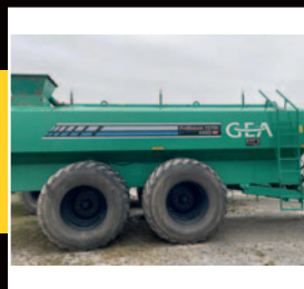
Épandeur GEA 4400 gal. 2021, PTO 1 000 tours, 2 essieux, 850/50/30.5 Nokian, directionnel, freins, jet central, ensemble de graissage
