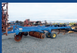
Combo Landoll 2410-6-24, 2012, 6 pattes aux 24 po, 2 rangées de disques concaves avant, 3 rangées de peignes arrière, tandem 38 500 $
