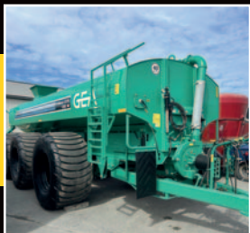
Épandeur GEA 6100 gal. 2022, PTO 1000 trs, freins triple manuel, 3 essieux, pneus Galaxy 850/50R32, susp. XT, rampe en Y, transfert de poids
