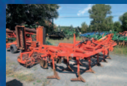
Déchaumeuse à pattes Maschio Terremoto 450, 4,5 m repliable, disques niveleurs, rouleau double
