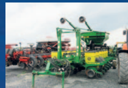
Planteur JD 1770NT, 16 rgs, boîte Aulari ALR 3002, engrais sec, maxEmerge XP, spring 400 lb, disques d'engrais simple, moniteur trak350, balance, marqueurs 59 900 $
