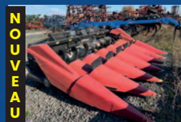
NOUVEAU Nez à maïs Geringhoff rotadisc, 6 rangs, adapteur case, deck plate ajustable hydraulique, stalk stompers, très propre
