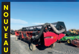
NOUVEAU Table à soya Case 3020, 35 pi, ajustement de la barre de coupe hydraulique, reel à l'air, faux schumacher
