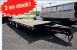
Remorque Asetrail à Timon, 3 essieux, freins à air, suspension à air, planche de 24 pi., descente de 5 pi
