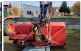
Souffleuse à neige Bervac SA88 , rotation et clapet hydrauliques
