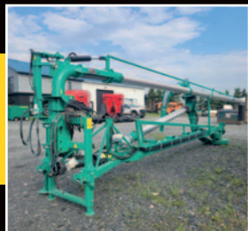
Pompe Agi pompe GEA 24 pi 8 po, 2023, PTO 1000 trs, manette élec., bras de chargement hydr. 8 po (Bras canadien) refroidisseur d'huile à Gearbox
