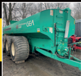
Épandeur GEA, 7900 gal 2014, PTO 1000 tours, 4 essieux, freins automatique double, pneus Galaxy Radial 850/50R32, rampe en Y, rehausse 18 po
