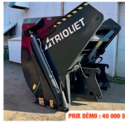
Godet Trioliet Triomaster S300, capacité de 4.1 m 3 , pour char- geur industriel, poids vide 2 150 kg, capacité de charge 1 800-2 000 kg, chargeur poids minimum requis 11 000 kg, avec une capacité de levage minimum de 8 500 kg, avec attache ISO / Volvo inclus, démonstration disponible
