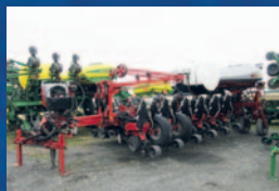
Planteur Case IH 1255 CCS, 16 rgs, 2017, V-Set / V-Drive élec. pression hydr. Delta force, pompe PTO, radiateur, tasses résidus Yetter, moniteur precision planting 20/20, engrais liquide pop-up, marqueurs, Smart box 115 000 $
