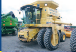
Batteuse New Holland TR99, 2000, 3 951/2 739 h, capteur humidité et rendement, 2 RM, roues doubles 18.4R42, 280 hp, big top 39 000 $
