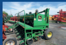
Semoir John Deere 1530, 15 pi, aux 15 po, unité de planteur à maïs, disques opener, marqueurs, balance
