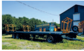
2 plateformes à foin Rolland RP11506, tourelle, freins aux 6 roues, avec suspension
