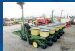
Planteur John Deere 7240, 6/11, vacuum, trak-250, disc openers, pression d'unité 4 springs
