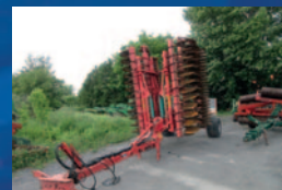
Déchaumeuse Kverneland qualidisc 6000, 6 m, rouleaux actipack, 2 points
