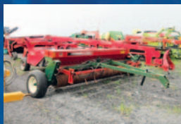
Semoir Brillion SS12, 12 pi, 2 compartiments, relevage hydraulique, rangée de dents en «S»
