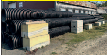
Tuyaux en plastique pour ponceaux
