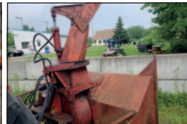
Souffleuse à neige, 92 po, tambour rotatif, rotation et clapet hydrauliques
