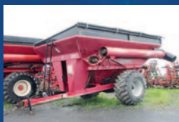
Grain Cart Demco 850, toile, bout de vis rotatif, pneus 30.5-32
