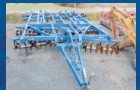
Combo Landoll 2410, 9 pattes aux 24 po, disques double con- caves avant, peignes et rouleau arrière 39 500 $
