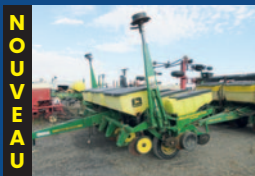
Planteur JD 1750 conservation, 6 rangs, engrais sec, semis direct, disques simple, tasses résidus, marqueurs, moniteur, boîtes 3 bu.
