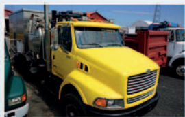
Camion Sterling , 10 roues, moteur diesel Caterpillar, écreur pour les égouts et réservoir auxiliaire
