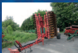
Déchaumeuse Kverneland qualidisc 6000, 6 m, rouleaux actipack, 2 points
