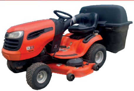
Tracteur à gazon Ariens 2248 , 22 hp, 2 cylindres, ramasse herbe Kohler, transmission hydrostatique, ensacheur
