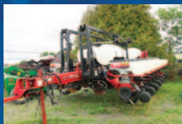
Planteur White 8180, 16 rangs, engrais liquide, marqueurs, disques d'engrais no-till, moniteur SM4000
