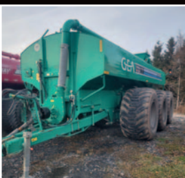
Épandeur GEA 5250 gal 2021, PTO 1000 tours, 3 essieux, 850/50/30.5 Nokian, directionnel, freins, jet central, ensemble de graissage
