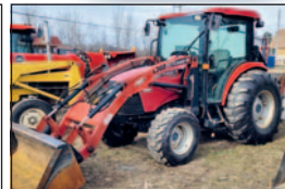
Tracteur Case Farmall 60 , 2009, cabine, chargeur à l'avant et excavatrice à l'arrière
