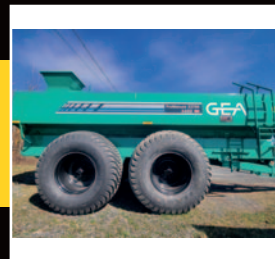
Épandeur GEA, 4400 gal. 2023, PTO 1000 trs, freins doubles, 2 essieux, pneu Alliance 850/50/30.5, transfert de poids, rampe en Y, entonnoir de 18 po, ensemble de graissage
