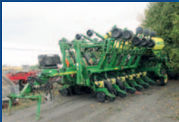
Planteur John Deere 1790CCS, 16/31, MaxEmerge XP, pression pneumatique, clutch à l'air, 20/20 precision planting, marqueur nouveau prix 89 000 $
