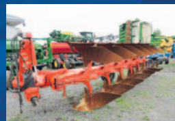
Charrue réversible Kuhn Vari-Master 182, 6 versoirs (5+1), ailes de raquin, disques sur le dernier versoir, ajust. hydraul., déclencheurs hydraul.
