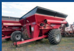
Grain Cart Demco 1050, roues 900/60R32, bout de chute rotatif, vis de 18 po
