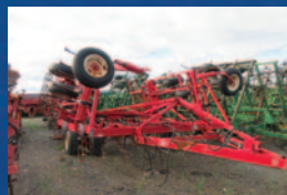
Vibroculteur Kongskilde 3800, 23 pi, finition 3 rangées de pick-tooth et rouleau simple, tandem dans les ailes, roues folles avant
