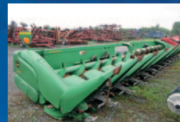
Nez à maïs John Deere 612C Stalkmaster, 2013, débraye rang par rang, 2 stalk stoppers, capteur de rang, capteur de hauteur 65 000 $
