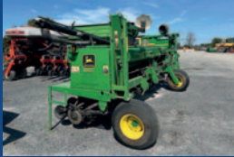
Semoir John Deere 1520, 15 pi, espacement aux 7.5 po, boîte à mils, marqueurs, vis de chargement, roues plombeuses 4 po
