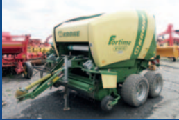
Presse Krone Fortima VI500 MC, 2014, tandem, chambre variable, rotocut 17 couteaux
