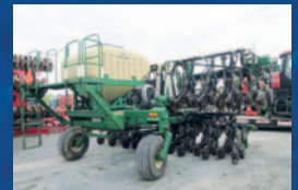
Planteur Great Plains 3PYPA-3115, stack fold, 12 rangs aux 15 po, avec cart pour la semence, écran Dickey John IntelliAg
