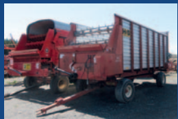
Boîte à ensilage H&S HD 7+4, 20 pi, combo, décharge à droite et à l'arrière
