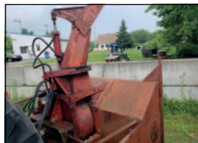
Souffleuse à neige, 92 po, tambour rotatif, rotation et clapet hydrauliques
