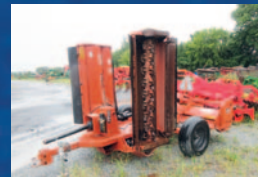
Débroussailluse Rhino FX17, trépanante, 3 sections
