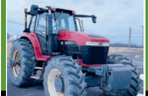
Tracteur Versatile 2180, 4RM, cabine, pesées avant
