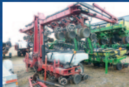
Planteur White 8772, 12 rangs stackfold, semis direct, Spring HD, tasses résidus, marqueurs, boîte 3 bu, moniteur
