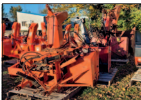
Souffleuse à neige, 72 po, tambour rotatif, rotation hydraulique
