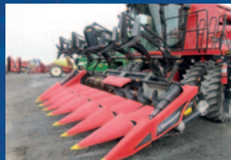
Nez à maïs Geringhoff RD830, 2012 rotadisc, vis aux extrémités, reel à palette hydraulique, fit CNH, reconditionné système rotadisc refait à neuf, chaînes neuves, très propre
