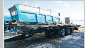
Remorque neuve (Farrier), 3 essieux, rampe hydraulique
