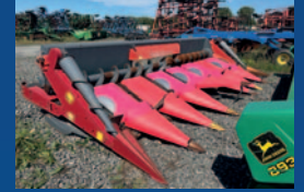
Nez à maïs Fantini L03, 2011, 8 rangs chopper, vis hydrauliques aux bouts, était sur une Case IH 8230
