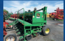
Semoir John Deere 1530, 15 pi, aux 15 po, unité de planteur à maïs, disques opener, marqueurs, balance
