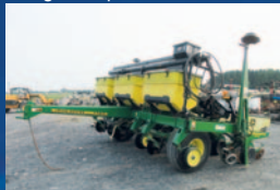
Planteur JD 1780, 6 rgs 30 po, engrais sec, rehausse + vis, disques à engrais no-till, Springs HD, boîtes 3 boisseaux, vacuum, engrais liquide pop-up, track 250, radar
