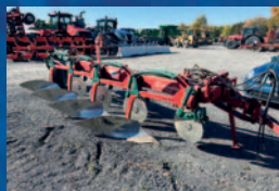
Charrue Kverneland BB115 HD, 4 versoirs, ajustable hydraulique, disques, très propre
