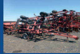
Cultivateur Case Tigermate II, 22 pi, tandem dans la base et les ailes, 4 rangées de peignes, roues de profondeurs
