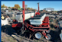
Planteur White 6100, 6 rangs, semis direct, disques d'engrais yetter, tasses résidus, engrais sec, marqueurs
