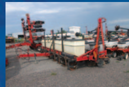
Planteur semi-direct Case 1200, 8 rangs, engrais sec, vis et rehausse d'engrais, no-till, disques Ausherman, marqueur, moniteur
