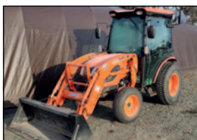
Tracteur Kioti CK4010HC, 2020, transmission hydrostatique, pneus à gazon, 2 sorties d'huile, chargeur avant
