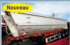
Nouveau Remorque Manac , 3 essieux, suspension à l'air, toile électrique, fond en Teflon, bien chaussée
