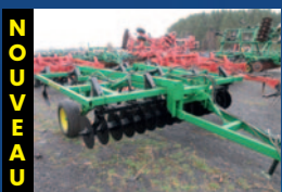
NOUVEAU Chisel John Deere 714, 9 pattes, disques droits, ajustables hydrauliques
