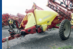
Arroseuse Hardi Navigator 3500, 60 pi, 4 sections, jet multiple, réservoir de prémélange, isobus John Deere
