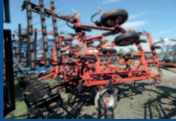
Cultivateur Case 4300, 24 pi, grosses dents, 3 rangées de peignes, tandem dans la base et les ailes
