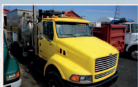
Camion Sterling , 10 roues, moteur diesel Caterpillar, écoreur pour les égouts et réservoir auxiliaire
