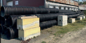
Tuyaux en plastique pour ponceaux
