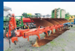
Charrue réversible Kuhn Vari-Master 182, 6 versoirs (5+1), ailes de raquin, disques sur le dernier versoir, ajust. hydraul., déclencheurs hydraul.
