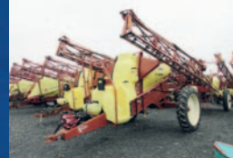
Arroseuse Hardi NP1100, 1 100 gallons, 90 pi, jet multiple, essieux ajustable, suspension sur l'essieu
