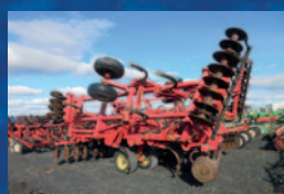
Chisel Sunflower 4530-19, 19 pattes repliable, avec disques avant et arrière 57 000 $
