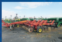
Chisel Sunflower 4212, 13 pattes, disques avant hydraulique, tandem, finition de pick-tooth
