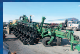
Planteur Great Plains YP1625A, 16 rangs twin rows, placés aux 15 po, écran dickey John, marqueur, clutch à l'air, disques opener 59 000$
