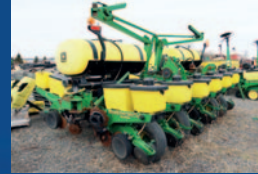
Planteur John Deere 1760 MaxEmerge Plus, 12 rangs, engrais liquide, marqueurs, rowcleaners + disc opener, springs HD, moniteur track 250
