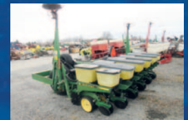
Planteur John Deere 7240, 6/11, vacuum, trak-250, disc openers, pression d'unité 4 springs
