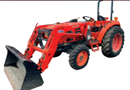
Tracteur Kioti DK35 , 2004, 3 500 h, 35 hp, 4 RM, chargeur avant, transmission 12x12, 2 sorties huile doubles, pneus agricoles, en très bonne condition
