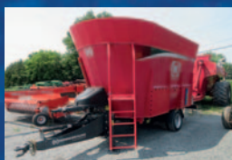
Mélangeur Kongsilde VMI4-2 SL, 2015, 2 vis, cellule de balance (sans l'écran), 14 m3, NEUF 33 500 $
