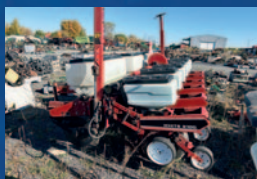
Planteur White 6100, 6 rangs, semis direct, disques d'engrais yetter, tasses résidus, engrais sec, marqueurs
