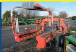
Enrobeuse Kverneland Taarup 7664, fait balles rondes et carrées, moniteur
