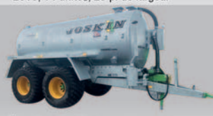
Épandeur Joskin , pompe vacuum, en acier galvanisé, pneus BKT 710/50R26.5
