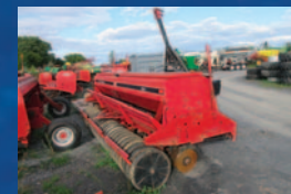
Semoir Case 6300, 14 pi, espacement au 6 pouces, boîte à mils
