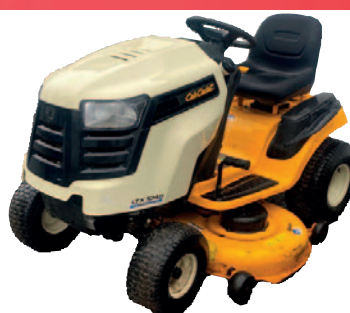
Tracteur à gazon Cub Cadet LTX1045 , 20 hp, moteur 1 cylindre Kohler, transmission hydrostatique, tondeuse 46 po
