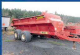
Épandeur Meyer Industrial 8720, batteurs verticaux, 3 vis, tandem
