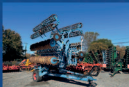
Déchaumeuse Lemken gigant 10 Rubin 9, 2014, 8 m, rouleaux doubles ajustables hydrauliques, très propre
