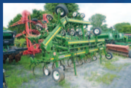
Sarcleur mi-lourd Wetherell Mfg Co 1700, 16 rangs repli- ables, largeur d'un 6 rangs pliés, roues de profondeur
