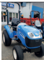
Tracteur New Holland Boomer 20, 2015, pneus à gazon, transmission hydrostatique
