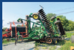
Herse à disques JD 2623VT, 2013, 30 pi de large, disques 22 po, rouleaux arrière pression hydraulique, disques et bear- ings neufs (500 acres) 55 000 $
