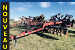
Combo Case IH 870, 2014, 9 pattes, espacement aux 24 po, disques niveleur et rouleaux arrière
