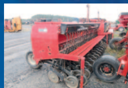
Semoir Case 5400, 15 pi, boîte à mil, roues plombeuses
