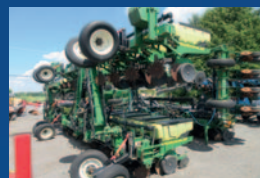
Planteur John Deere 1720, 16 rgs, boîtes 3 minots, moniteur 20-20 et eSet meters, tasses résidus, wheel assists, vacuum, roues billons, ferme en 3 sections
