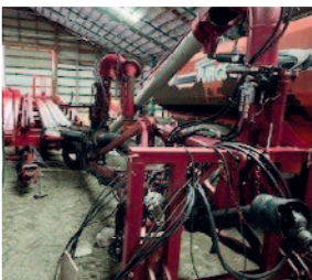
Pompe Jamesway Pumpeller , 2015, 8 po, PTO 540, bras de chargement articulé, manette sans fil pour trappe de chargement et ajustement de la hauteur du tuyau, pour fosse de 12 pi 15 000 $
