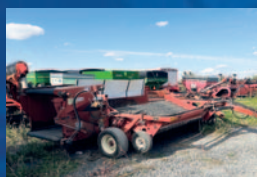
Doubleur d'andain H&S HSM9, 9 pi de pick-up, hydra swing, moteur hydraulique, dents de plastique, extension de 2 pi
