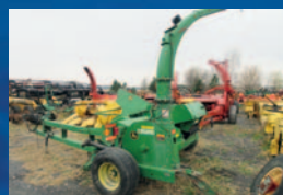
Fourragère John Deere 3975, Iron guard, rouleau craqueur, pick-up à foin
