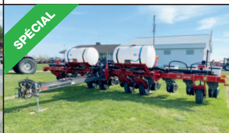
Planteur neuf Massey Ferguson VW1230 VE, 2023, 12 rangs, repliable, avec marqueur de rang et nettoyeur de résidus, engrais liquide, espacement des rangs 12R30, Vacuum électrique
