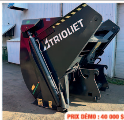
Godet Trioliet Triomaster S300, capacité de 4.1 m³, pour char- geur industriel, poids vide 2 150 kg, capacité de charge 1 800-2 000 kg, chargeur poids minimum requis 11 000 kg, avec une capacité de levage minimum de 8 500 kg, avec attache ISO / Volvo inclus, démonstration disponible
