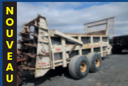
NOUVEAU Épandeur Kuhn Knight 2054, batteurs verticaux, porte hydraulique, hydropush, pneus ballon, prêt pour la saison
