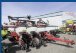
Planteur White 8100, 12 rangs, repliable, boîtes longues 3 minots, pas d'engrais, marqueurs, disques opener
