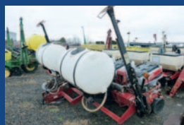
Planteur White 8106, 6 rangs, engrais pop-up (démarrateur), marqueurs
