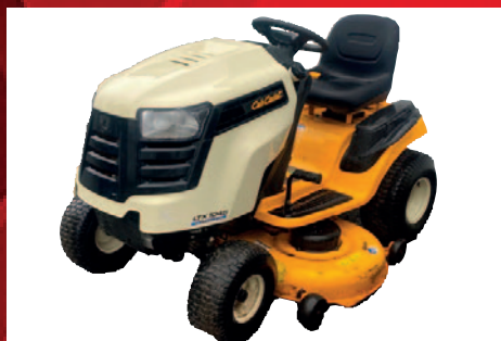
Tracteur à gazon Cub Cadet LTX1045, 20 hp, moteur 1 cylindre Kohler, transmission hydrostatique, tondeuse 46 po
