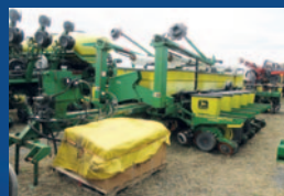
Planteur JD 1770, 16 rangs, semis-direct, disques d'engrais simple, pression pneumatique, tasses résidu ajustable pneumatique, rehausse et vis d'engrais, vacuum, marqueurs, moniteur
