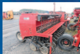
Semoir Case 5400, 15 pi, boîte à mil, roues plombeuses
