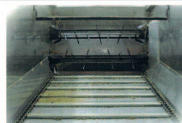
Intérieur de cuve en acier inoxydable et convoyeur à chaînes
