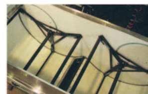
Cuve avec double batteurs de mélange, fond et côtés recouverts d'un plastique antiadhésif et traité UHMW
