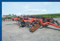
Combo Case IH MRX690, 7 pattes, disques avant et arrière, relevage hydraulique
