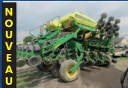
Planteur John Deere 1790 CCS, 12/23, disques opener, engrais liquide sur le rang, entraînement mécanique, pression pneumatique
