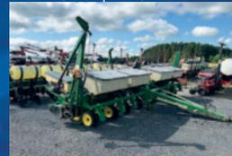
Planteur John Deere 1750 conversion, 8 rangs, engrais granulaire, boîtes 3 bu., disques d'engrais simple, marqueurs, vacuum, spring pression HD
