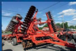
Herse à disques vertical Kuhn Krause Excelerator 8005-30, 2017, 30 pi, disques ajustables hydrauliques de 1 à 5o, star wheel hydraul. et rouleau, hitch arrière, très propre **84 000 \$**
