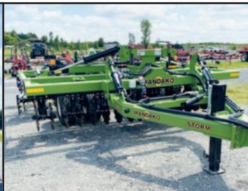
**Mandako Euro Storm S1320**, 2023, 3,9 m, écartement des lames de 25 cm, angle de barre d'outils réglable de 0 à 14 (en marche), roulement hydraul. et avec herse à dents à 2 barres
