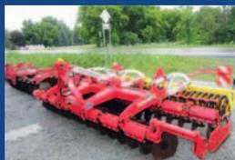
Déchaumeuse Pöttinger Terradisc 4001, 2013, porté (3 points) rouleau profilé ajustable hydraulique
