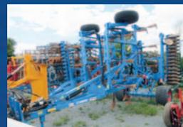
Déchaumeuse à pattes Lemken Karat 9 KUA, 2016, 6 m, 21 pattes, roues de profondeurs, disques niveleur, rouleaux doubles 55 000 \$
