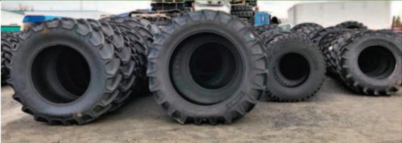
Plusieurs pneus agricoles de différentes grandeurs, ex.: 18.4x26, 440-65x24, 18.4x46 et autres
