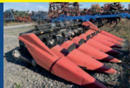
Nez à maïs Geringhoff rotadisk, 6 rangs, adaptateur case, deck plate ajustable hydraulique, stalk stompers, très propre
