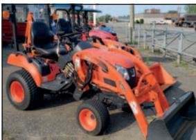
Tracteur **Kioti** CS2210, transmission HST, chargeur avant, pneus gazon
