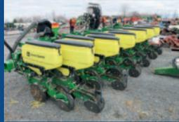
Planteur JD 1705, 2015, 6 rangs twin rows (36 po), 3 points, vacuum, pression pneumatique, population hydraulique, kit engrais liquide 29 900 \$
