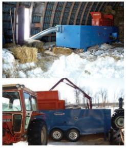
Équipements Tremzac de St-Bonaventure, comté de Drummond (Québec), vient de lancer une machine apte à transformer des billots de bois en ripe pour litière d'animaux de ferme. Stationnaire ou portable, conçue pour des billots de 4 ou 8 pieds, cette machine peut être utilisée sur une ferme et permettre ainsi au producteur, de fabriquer sa propre ripe.
