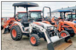
Tracteur Bobcat CT225, 2009, 982 h, 27 HP, 3 cylindres, chargeur 77L, 1 sortie d'huile, pneus industriels
