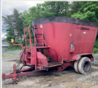
Mélangeur Supreme International 900 T , rehausse de 10 po, 1 000 tr/min, convoyeur plat de 10 pi, avec balance
