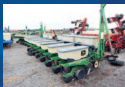
Planteur John Deere 1750 conservation, 8 rangs, engrais granulaire, boîtes 3 bu., disques d'engrais simple, marqueurs, vacuum, spring pression HD
