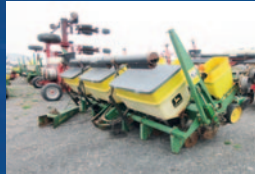
Planteur John Deere 7200 Conservation, 6 rangs, vacuum, spring HD, vis et rehausse engrais, disques simples + tasses résidus, rehausse de boîte de semences
