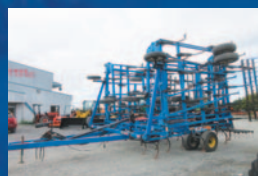
Cultivateur DMI tigermate II, 50 pi, 3 rangées de peignes, tandem, roues de profondeur avant
