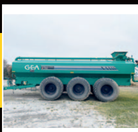
ÉPANDEUR GEA 6100 2021, PTO 1000 tours, 3 essieux 850/50/30.5 Nokian, directionnel, freins, jet central, ensemble de graissage (2 ans de travail)
