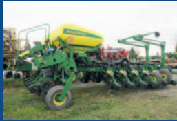
Planteur JD 1770NT, 16 rgs, disques d'engrais no-till, clutches électriques, tasses résidus, pression pneumatique, marqueur, isobus, (pas de réservoir d'engrais liquide) 89 900 $
