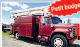
Camion International , moteur diesel DT466, automatique, équipé d'une nacelle
