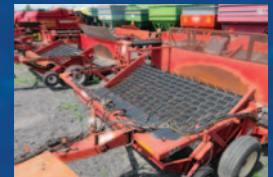
Doubleur d'andain H&S HSM9, 9 pi de pick-up, hydra swing, moteur hydraulique, dents de plastique, extension de 2 pi
