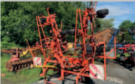
Faneur à foin Kuhn GF 8501 MH , 8 toupies, attelage sur 3 points, ouverture hydraulique, en très bonne condition.
