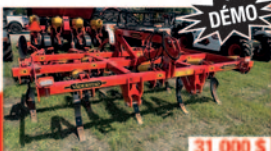
Déchaumeuse Väderstad CS 350 Cultus 350, 12 dents aux 12 po sur 3 rangées, largeur de travail de 3,5 m
