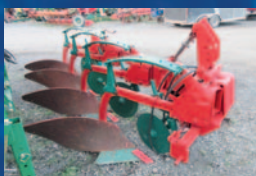
Charrue Kverneland AB100, 4 versoirs, disques, porté, roues de profondeur, variable hydraulique
