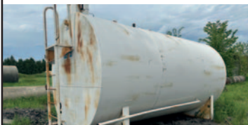
Réservoir de 5 000 gal avec base et échelle, extérieur en métal et intérieur en époxy
