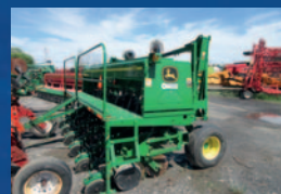
Semoir John Deere 1530, 15 pi, aux 15 po, unité de planteur à maïs, disques opener, marqueurs, balance
