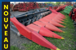
Nez à maïs Geringhoff RD800, rotadisc, 8 rangs, était sur une batteuse Case 2388, en bonne condition
