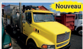
Camion Sterling , 10 roues, moteur diesel Caterpillar, écoureur pour les égouts et réservoir auxiliaire
