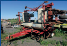
Planteur White 6100, 8 rangs repliables, engrais sec, semis direct, disques d'engrais Yetter, tasses résidus, marqueur, moniteur
