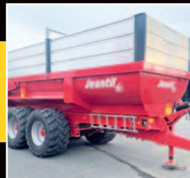
Benne TP 22-29 3 pi de réhausse, pneus 650/55R26.5 BKT, capacité de 20 t grain, paroié Hardox ¼
