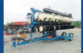
Planteur Kinze 3500, 8 rgs pivot, engrais sec, vis de chargement, engrais liquide, 16 disques engrais no-till, pression pneumatique, Agleader SureDrive (moteur élec.), vacuum, marqueurs, 79 000 $
