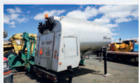
Réservoir à eau, en aluminium avec pompe.
