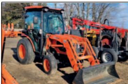
Kioti CK3510HC, 2018, 446 h, hydrostatique, pneus à gazon, 2 s. d'huile, chauffe-moteur, cabine de luxe, chargeur KL4030
