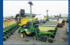
Planteur JD 1780, 6 rgs 30 po, engrais sec, rehausse + vis, disques à engrais no-till, Springs HD, boîtes 3 boisseaux, vacuum, engrais liquide pop-up, track 250, radar
