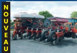
Planter Case 1250, 16 rangs, pression pneumatique, engrais liquide pop-up (sans réservoir), population variable, isobus
