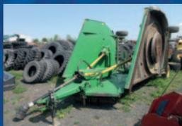
Faucheuse John Deere CX20, 20 pi repliable, 3 sections, suspension à l'air
