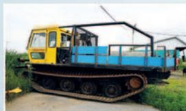
Chenille **Bombardier** Go-Tract GT-2000 WT, moteur diesel Cummins 8.3 l, transmission Spicer
