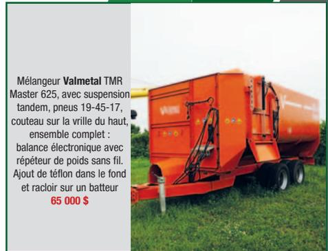
Mélangeur Valmetal TMR Master 625, avec suspension tandem, pneus 19-45-17, couteau sur la vrille du haut, ensemble complet : balance électronique avec répéteur de poids sans fil. Ajout de téflon dans le fond et racloir sur un batteur 65 000 \$
