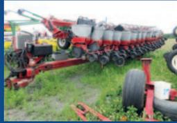
Planteur Case 1240 16/31 rangs, pivot, pompe PTO avec radiateur, pression pneumatique, marqueurs, central fill (boîte de semence rehaussé), 6 roues sur le transporteur
