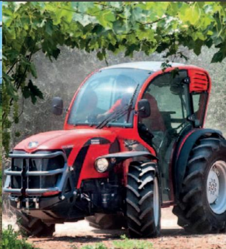
Les tracteurs à profil bas TGF 7800 S 4F de 71 HP et TGF 8900 R (illustré) de 75 ou 98 HP, avec transm. 16 x 16, roulent jusqu'à 40 km/h.
