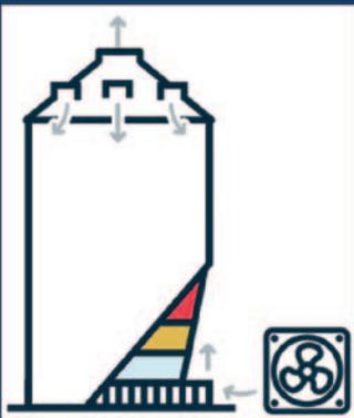
AgriLog présente Silog<sup>MC</sup>, un système d'automatisation connecté qui vous permet de contrôler entièrement la ventilation de vos cellules d'entreposage. Le système Silog assure un suivi des conditions météorologiques sur place et ajuste la ventilation en fonction de celles-ci et de vos objectifs d'entreposage (séchage, maintien, refroidissement, etc.).
