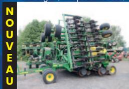
Semoir John Deere 1890CCS, 36 pi, espacement aux 7.5 po, moniteur Trak350, en bonne condition
