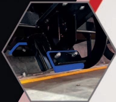
**2** Le boîtier à chaîne étanche augmente la durée de vie de la chaîne et réduit les intervalles de maintenance.
