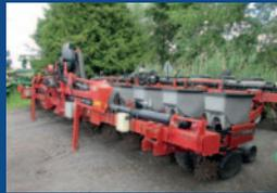
Planter Case 1230, 12 rangs, stackfold, tasses résidus, hydraulique drive, Trimble (sans écran)
