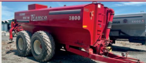
Épandeur **Teamco** 3800 gallons refait à neuf il y a 6 ans, jet y, impaler 540trs, châssis Bodco avec direction, bon pneus 23.1L26,
