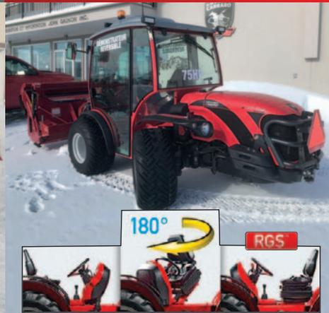
Les TR / TTR, SR 7600 (articulé), de 75 HP ou le TONY TTR 8900 de 98 HP avec transmission hydrostatique variable et poste de conduite réversible, offrent une visibilité supérieure, roulent jusqu'à 40 km/h et facilitent les travaux de déneigement.
