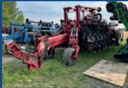
Planter Case IH (GreatPlains) 1225AFF, 12 rangs twin-rows (rang jumelé), air-pro, marqueurs, clutch à l'air, tasse-résidus/disc opener, engrais liquide pop-up avec réservoir. **59 900\$**
