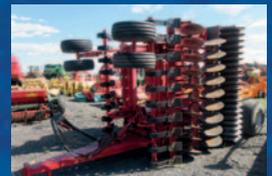
Déchaumeuse Heva Disc roller, 5 m, 2012, planche niveleuse hydraulique, rouleau, roues de profondeur avant
