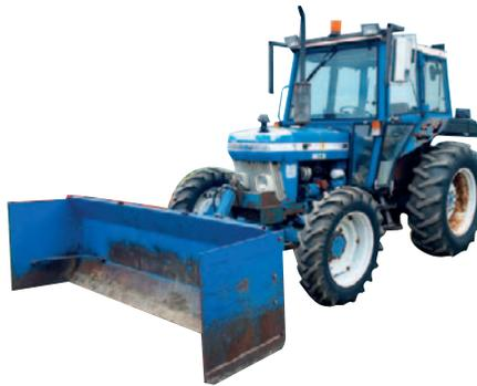
**Ford** 3910, 1988, 2 000 h, 45 HP, 4 RM, cabine, grappe avant, 2 sorties huile, pompe hydraul. double, transm. synchronisée 8X4, très bonne mécanique
