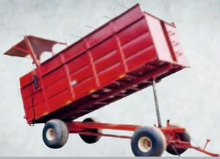
Remorques à benne basculante de 5 x 10 à 8 x 24 pi, capacité de 10 à 30 t
