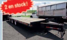
Remorque **Asetrail** à Timon, 3 essieux, freins à air, suspension à air, planche de 24 pi., descente de 5 pi
