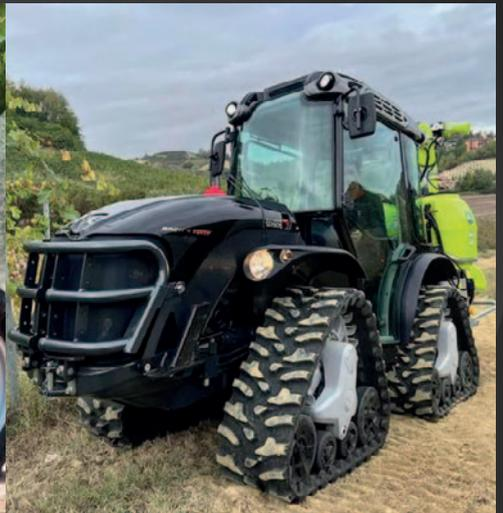
Le tracteur Mach 4 R articulé et oscillant (ACTIO), avec poste de conduite réversible, est monté sur 4 chenilles pour une meilleure traction et moins de compaction.
