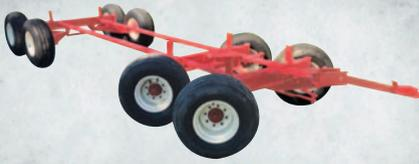
Wagons 4, 6 ou 8 roues, capacité jusqu'à 30 000 kg
