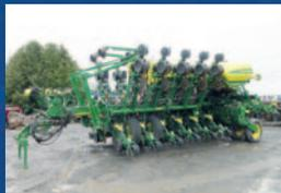
Planter JD 1795, 2017, MaxEmerge 5, 16/31, clutch électrique, engrais liquide avec rate contrôler JD, population hydraulique, pression pneumatique active, marqueurs, disc openers. **169 000 \$**
