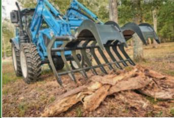
Grappin « polyvalent » LS Tractor MTC5572A de 72 po de largeur, 25 po de profondeur et 33 po de hauteur (fermé), 9 dents avec une ouverture maximale de 36 po, 2 cylindres, capacité de levage de 525 lb.
