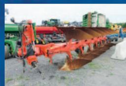
Charrue réversible Kuhn Vari-Master 182, 6 versoirs (5+1), ailes de requin, disques sur le dernier versoir, ajustable hydraulique, déclencheurs hydraulique
