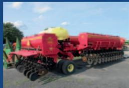
Semoir Sunflower 9434-40, 40 pi, réservoir engrais liquide, roues plumbeuses
