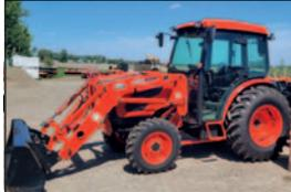
**Kioti** DK5510MB, 2021, 113 h, transmission manuelle 8 x 8, 2 s. d'huile, cabine, chargeur KL5520, pneus agricoles
