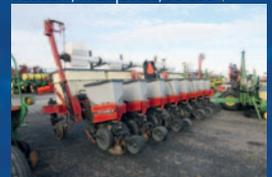
Planter Case 1220, 8 rangs, engrais sec, vis de chargement, engrais liquide, 16 disques engrais no-till, pression pneumatique, marqueur, moniteur pro 600
