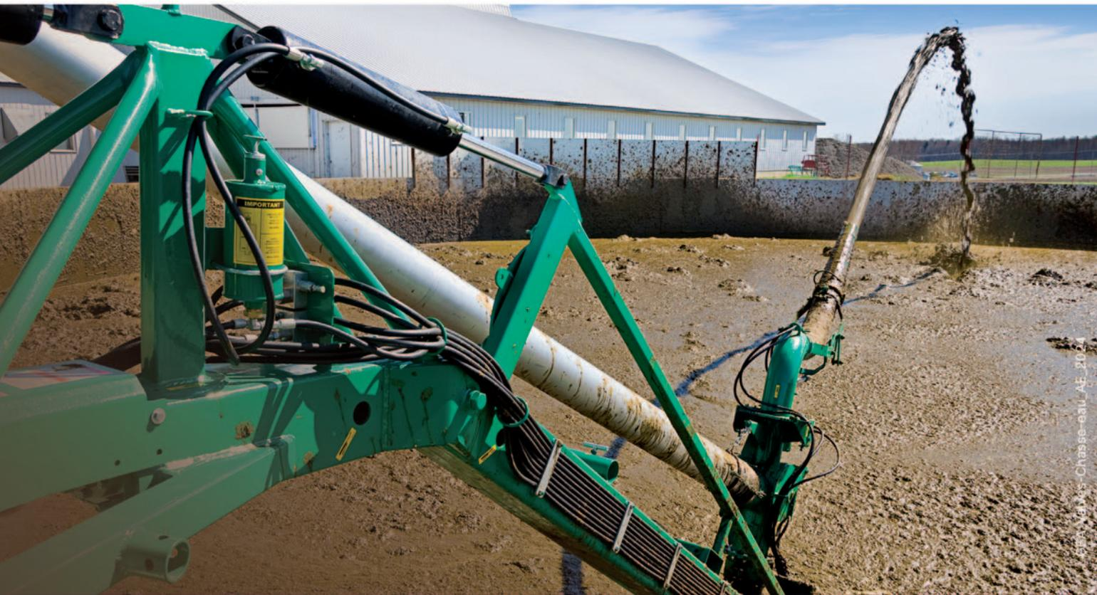
L'Agi-Pompe articulée se distingue par son hélice offrant une agitation constante jusqu'à 18 000 gal/min, autant en mode chargement qu'en mode agitation. L'articulation verticale de 40° du caisson plus le jet d'agitation permettent de réduire significativement le temps pour homogénéiser le contenu de la fosse.
