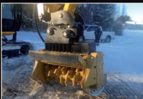
Broyeur hydraulique, pelle, 3 à 35 tonnes
