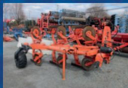
Charrue réversible Kuhn Multi-Master 152, 3 versoirs, disques, déclencheurs hydrauliques, ajustable à boulon
