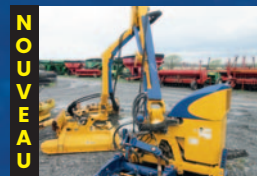
Débroussailleuse télescopique Bomford HAWK EVO 5.4, tête rotative 2 couteaux (17.9 pi de portée)
