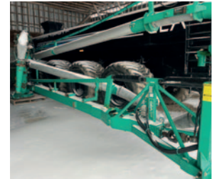
Agi pompe articulée GEA 2023, à lisier, tuyau de 6 po, longueur 21 pi, PTO 1000, pour fosse 16 pi, caisson en Hardox (option 22 po), refroidisseur d'huile, tuyau de chargement 8 po, coude anti-lévee
