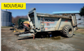
Épandeur Pichon M1450, vertical, avec porte arr. hydraulique, pneus 750/65X26
