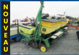
Planteur JD 1750 conservation, 8 rangs, rehausse et vis d'engrais, semis direct, disques simples, disques opener, marqueurs, moniteurs
