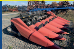
Nez à maïs Geringhoff rotadisc, 6 rangs, adapteur case, deck plate ajustable hydraulique, stalk stompers, très propre
