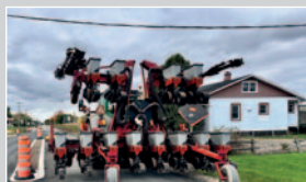
Planter Case 12 rangs, 30 po, « stack fold »
