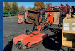
Débroussailleuse Land Pride DBM2660, 1000 tours, extensibles, roues de profondeur, comme neuve
