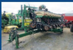
Planteur Great Plains YP825AR, 2014, 8 rangs twinrows (16 rangs) pivot, engrais liquide pop-up, moniteur PM300, disques openers, marqueurs 49 000 $
