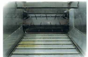
Intérieur de cuve en acier inoxydable et convoyeur à chaînes
