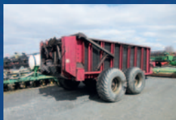
Épandeur Hagedorn Hydra-Spread 410, 2 batteurs, porte hydraulique, tandem, hydropush
