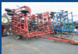
Cultivateur Case Tigermate II, 48 pi, roues de profondeur avant, 5 rangées de herse
