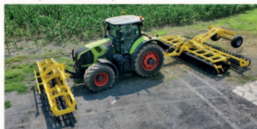
Rouleau hacheur de résidus avant et déchaumeur arrière
