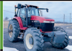
Tracteur Versatile 2180, 4RM, cabine, pesées avant
