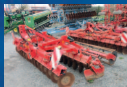
Déchaumeuse Kverneland Qualidisc 3500, 3,5 m, portée, rouleau cage ajustable hydraulique
