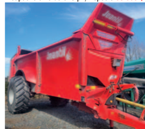
Épandeur solide Jeantil EV18-14 de précision, 2020 (vendu en 2022), 2 phases, 18 m³, panneau de contrôle pour débit, batteur horizontal, 650/75R32, balance, débit proportionnel à l'avancement, PTO 1000 tours
