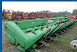
Nez à maïs John Deere 612C Stalkmaster, 2013, débriège rang par rang, 2 stalk stompers, capteur de rang, capteur de hauteur 65 000 $
