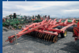
Chisel Sunflower 4213, 11 pattes, disques avant hydrauliques, tandem
