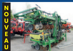
Planteur JD 1720 MaxEmerge XP, 12 rgs stackfold, marqueurs, population variable hydraul., tasses résidus, distributeur Precision planting E-Set, Isobus JD
