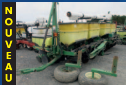
Planteur John Deere 1700 conservation, 8 rangs, rehausse et vis d'engrais, disques d'engrais simple, kit de transport, marqueur, moniteur
