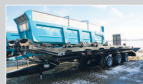
Remorque neuve (Farrier), 3 essieux, rampe hydraulique
