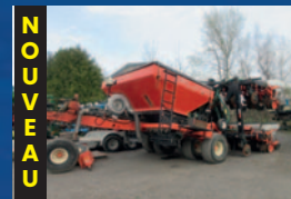
Planteur Kuhn Maxima, 12 rangs, engrais sec LADS FP 6000H (roues triples), disques d'engrais, tasses résidus, moniteur
