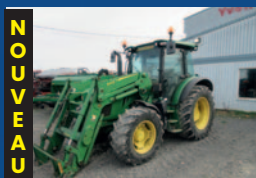
Tracteur John Deere 5100R, 2017, 3 128 h, chargeur 540R, transm. CommandQuad, reverse au volant, suspension sur la cabine, 2 sorties d'huile, 480/70R34
