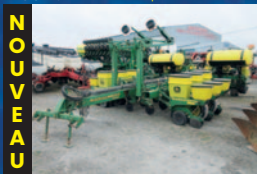
Planteur John Deere 1770, 12 rangs, engrais liquide, HD Spring, disques doubles, moniteur track 250
