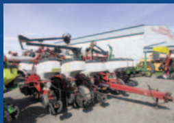
Planteur White 8100, 12 rangs, repliable, boîtes longue 3 minots, pas d'engrais, marqueurs, disques opener
