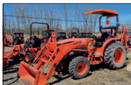
Tracteur Kubota L3540, 2010, 990 h transm. hydrostatique, pneus ind., chargeur LA514 et excavatrice BH76
