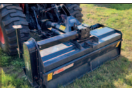
Rotoculteur MK Martin RT606, largeur 58 po, 6 couteaux par rangée
