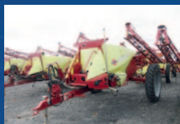
Arroseuse Hardi Navigator 3500, 1000 gallons, 60 pi, moniteur Hardi, 3 sections, jets multiples, réservoir de prémélange
