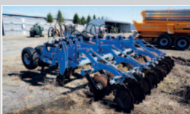
Sous-soleuse à pattes Michel, 6 raies, avec déclencheur hydraulique
