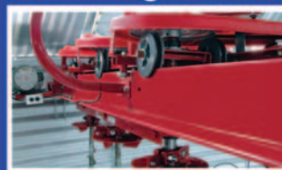
Système Red Giant à 4 vis 550V & moteur 7.5hp avec track neuve 24'
