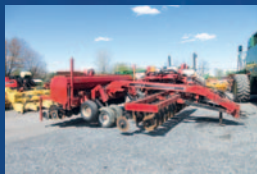
Semoir Case 5400, 15 pi, marqueur, semis direct (no-till), cart Case 5000 avec disques
