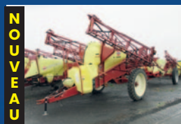
NOUVEAU Arroseuse Hardi NP1100, 90 ou 100 pi, 5 sections, essieux suspendu et ajustable, moniteur HC2500, pompe hydraulique
