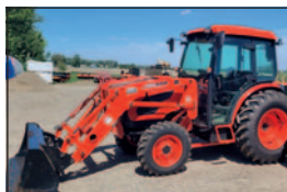
Tracteur Kioti DK5510MB, 2021, 113 h, transm. manuelle 8 x 8, 2 s. d'huile, cab. chargeur KL5520, pneus agricoles
