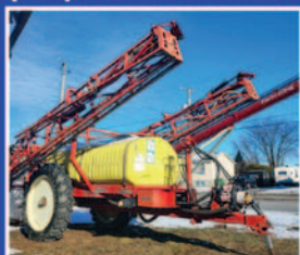
Pulvérisateur 750 gallons rampe 66' Hydraulique
