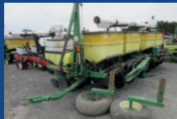
Planteur John Deere 1750 conservation, 8 rangs, rehausse et vis d'engrais, disques d'engrais simple, kit de transport, marqueur, moniteur
