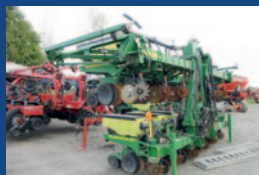
Planteur JD 1720 MaxEmerge XP, 12 rgs stackfold, marqueurs, population variable hydraul., tasses résidus, distributeur Precision planting E-Set, Isobus JD
