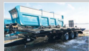
Remorque neuve (Farrier), 3 essieux, rampe hydraulique
