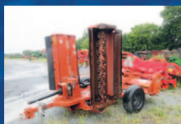
Débroussailluse Rhino FX17, traînante, 3 sections
