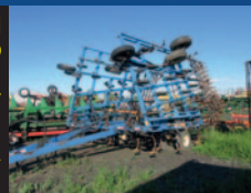
Cultivateur DMI Tigermate 2, 30 pieds, 5 rangées de pick-tooth, roues de profondeur avant
