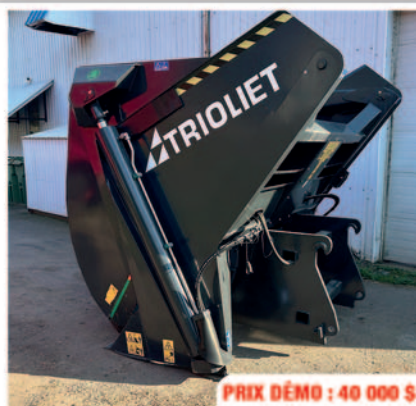
Godet Trioliet Triomaster S300, capacité de 4.1 m³, pour char- geur industriel, poids vide 2 150 kg, capacité de charge 1 800-2 000 kg, chargeur poids minimum requis 11 000 kg, avec une capacité de levage minimum de 8 500 kg, avec attache ISO / Volvo inclus, démonstration disponible
