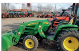
Tracteur John Deere 3038, 2011, 1 098 h, pneus industriels, 2 sorties d'huile, chargeur avant
