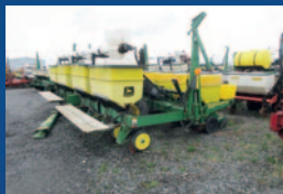
Planteur John Deere 1780 conservation, 8 rangs, semis direct, rehausse et vis d'engrais, tasses résidus, marqueurs, moniteur
