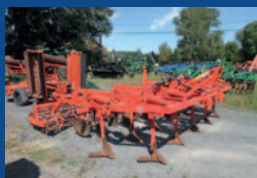
Déchaumeuse à pattes Maschio Terremoto 450, 4,5 m repliable, disques niveleurs, rouleau double
