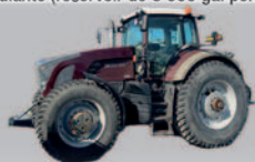
Tracteur Fendt 936, 2009, 6800 h, pneus Nokian 480/80R34 et 620/80R42, transmission IVT, relevages avant et arrière
