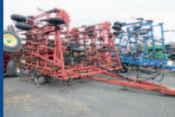
Cultivateur Case Tigermate II, 48 pi, roues de profondeur avant, 5 rangées de herse
