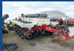
Planteur White 8180, 16 rangs, tasses résidus, engrais sec, rehausse et vis d'engrais, boîte 3 boisseaux, pompe PTO, moniteur
