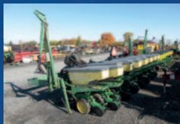
Planteur John Deere 7240, 8/15, vacuum, boîtes 3 bu., marqueurs, disques opener
