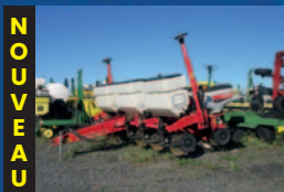
Planteur White 8100, 6 rangs, semis direct, disques d'engrais Auluri, boîtes 3 boisseaux, ressorts HD, rehausse d'engrais, moniteur, très propre
