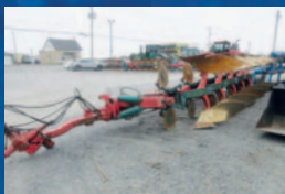
Charrue réversible Kverneland PB115, 5 versoirs, disques
