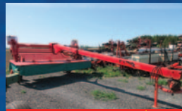
Faucheuse Kverneland Taarup 4040C, pole central, tête girondine, conditionneur à fléaux
