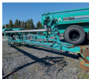
Agi pompe GEA 6 po x 21 pi, 2015, pour fosse 14 pi, PTO 540, contrôle hydraulique, tuyau sur trépied
