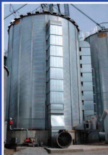
Silo séchoir Autoflow avec vis de déchargement
