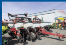
Planteur White 8100, 12 rangs, repliable, boîtes longue 3 minots, pas d'engrais, marqueurs, disques opener
